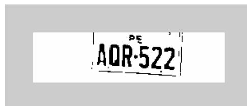
**Figura 5.16** Imagen binarizada utilizando el umbral obtenido de la figura 5.15 sobre la imagen original fig. 5.11
