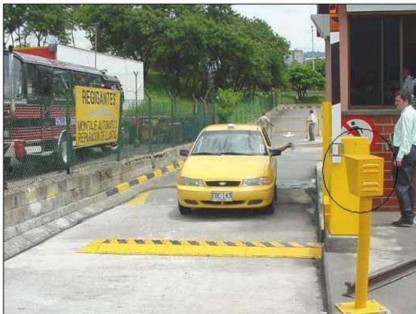
**Figura 1.10.** Sistema comercial de identificación de vehículos utilizado en otros países, la cámara se encuentra alojada en una carcasa metálica como se indica en la figura.
