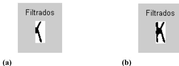
**Figura 4.29** Comparación en la extracción de un carácter, al incrementar la sensibilidad en Sobel
