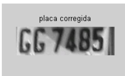
**Figura 4.42.** Imagen corregida con la Transformación Projectiva y la contribución de la Transformada de Hough
