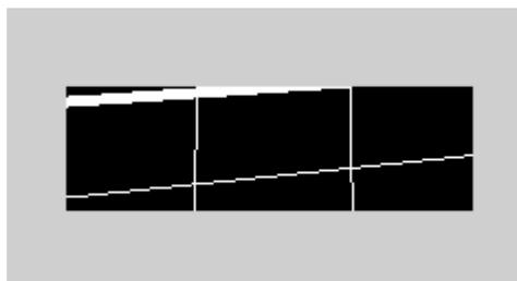
**Figura 4.37** Proceso iterativo automático de búsqueda de intersecciones, el proceso termina al encontrar los dos puntos de corte
