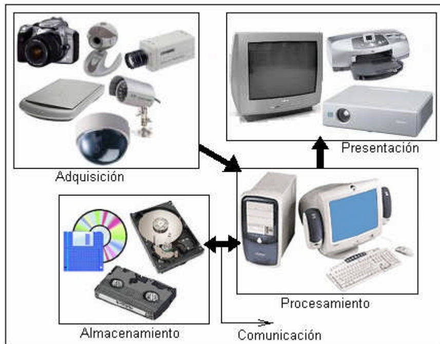
Figura1.1. Elementos básicos de un sistema de procesamiento de imágenes
