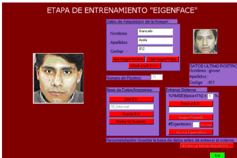
Fig. 7.6. Etapa de Entrenamiento del sistema con Eigenfaces
