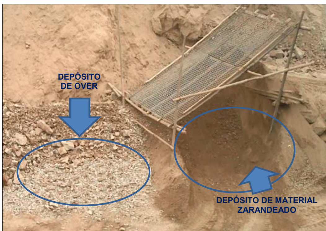
Figura N° 2.22. Estado inicial de la zaranda "vacío".
