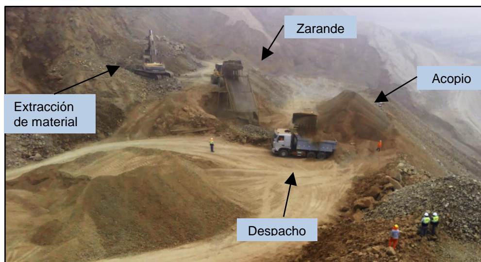
Figura N° 2.16. Diagrama del proceso de abastecimiento de material - cantera Coronel.
