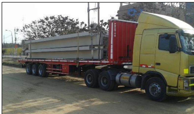
Figura N° 2.3. Camión cama baja en proceso de traslado de vigas pre-fabricadas.
