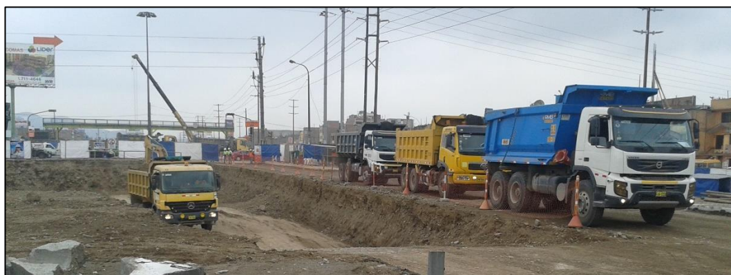
Figura N° 2.21. Volquetes con capacidad de tolva de 17m 3 y 15m 3 .
