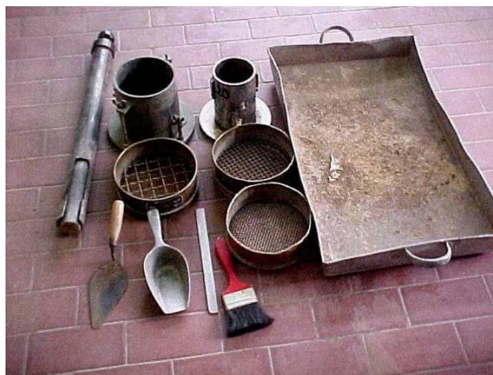
Figura 3.8: Equipo usado para el ensayo Proctor modificado
