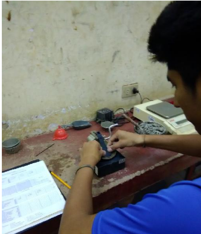
Figura 9: Ejecucion de abertura en la copa Casa Grande para límite líquido
