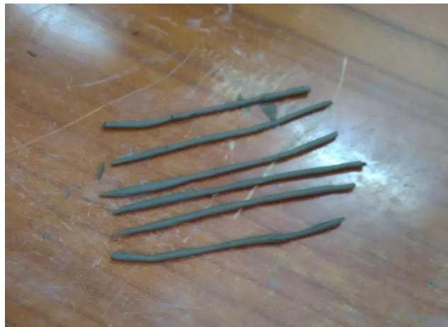
Figura 3.4: Elaboración de barras cilíndricas para el cálculo del límite plástico
