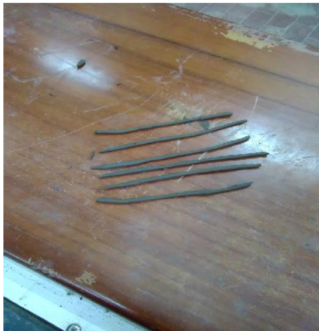
Figura 10: Realización de cilindros de 3,2 mm para el ensayo de límite plástico
