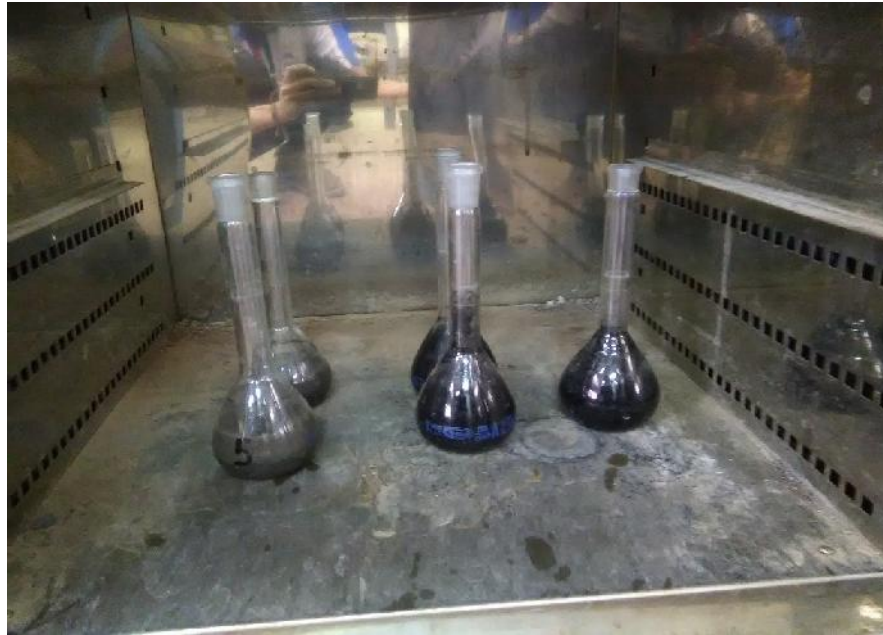
Figura 11: Desairado de agua mediante ebullición.
