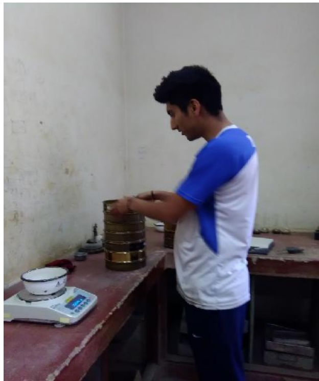
Figura 6: Tamizado de suelo, ceniza o mezcla a estudiar para el análisis granulométrico.
