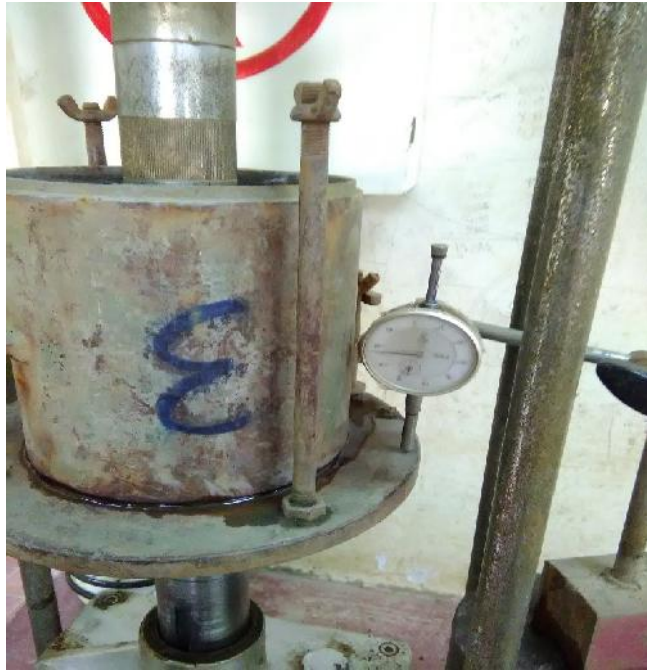
Figura 17: Instalación de molde de 56 golpes para la penetración con la prensa de CBR
