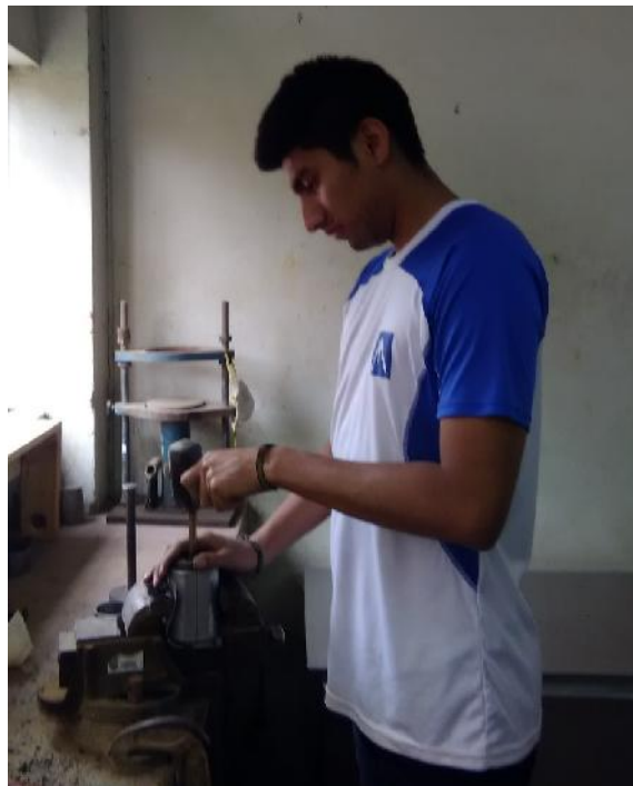
Figura 22: Compactación de suelo por capas.
