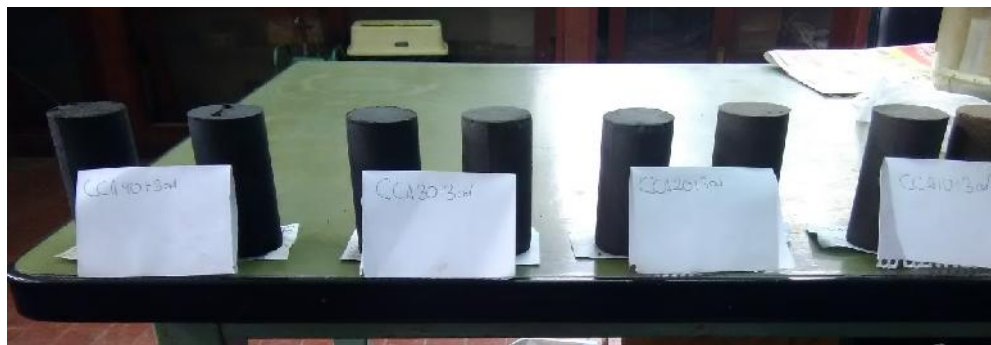
Figura 24: Muestras de suelo-CCA-CAL para la ejecución del ensayo de Compresión No Confinada
