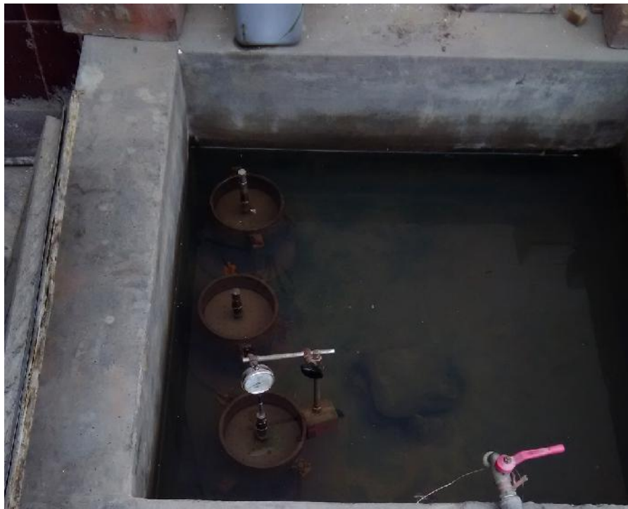
Figura 16: Colocación de moldes en poza de saturación
