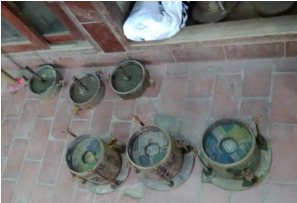
Figura 19: Culminación de ensayo con penetración de 0.5" en cada molde.
