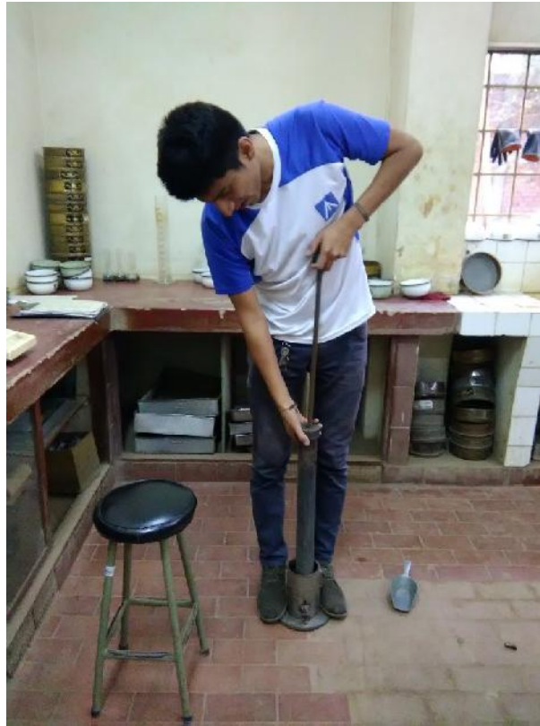
Figura 13: Compactación de primera capa con pisón de 10 lb.
