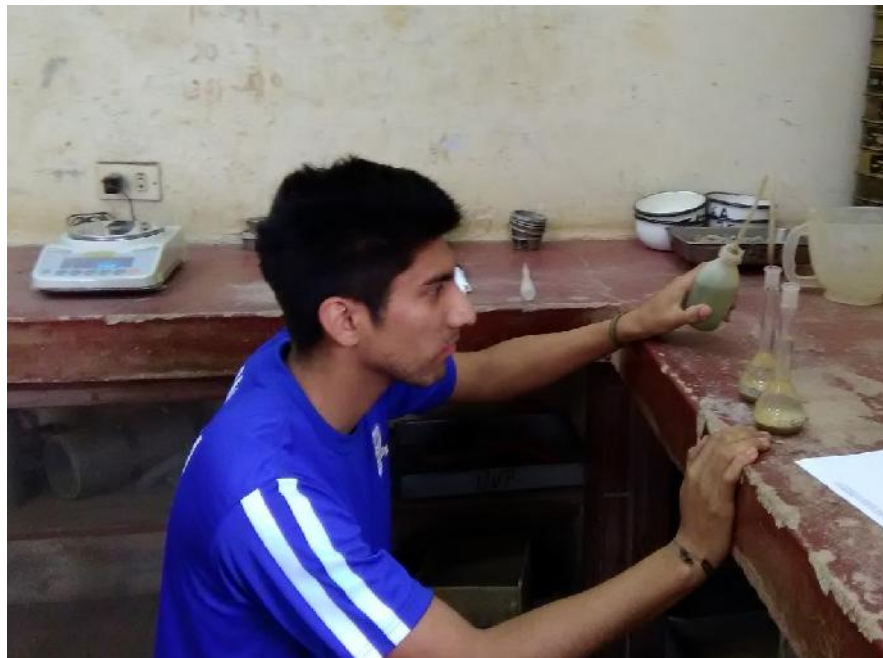
Figura 12: Llenado de picnómetros con agua destilada.
