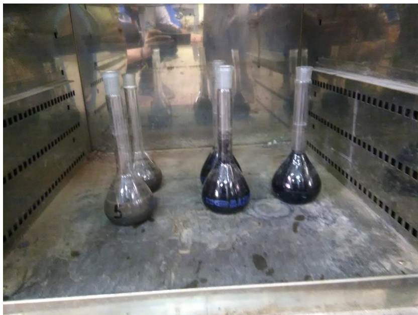
Figura 3.5: Desairado de agua mediante el método de ebullición en hornos.
