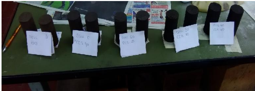
Figura 23: Muestras de suelo-CCA para la ejecución del ensayo de Compresión No Confinada
