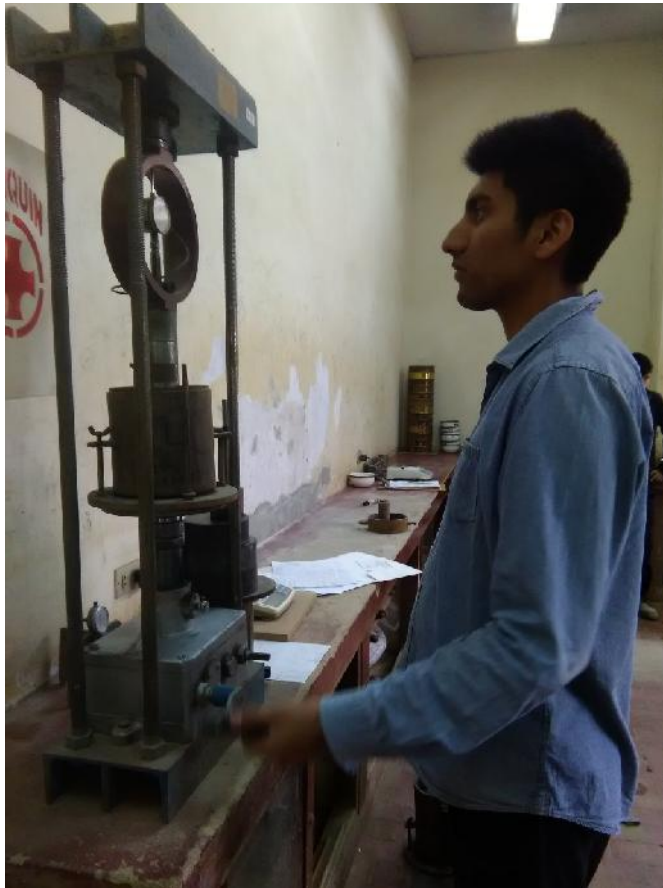
Figura 18: Penetración de molde para la ejecución del ensayo CBR.
