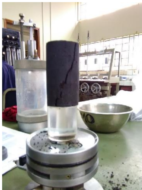
Figura 25: Falla frágil de la mezcla Ceniza 20% con suelo 80%.
