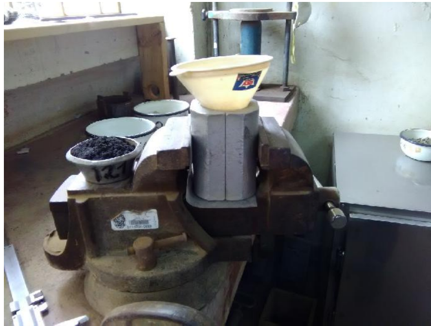
Figura 21: Colocación de suelo por capas.
