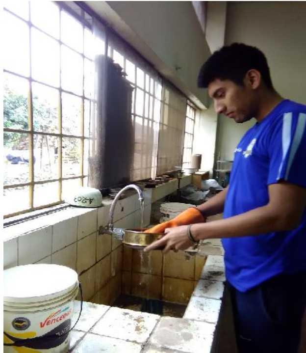
Figura 5: Lavado de material con el tamiz de malla N° 200
