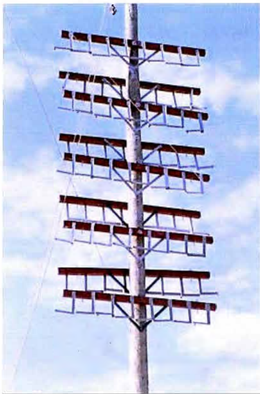
Foto N°7: Vista del Panel de perfiles pintados con diferentes tipos de intura y sistema .
