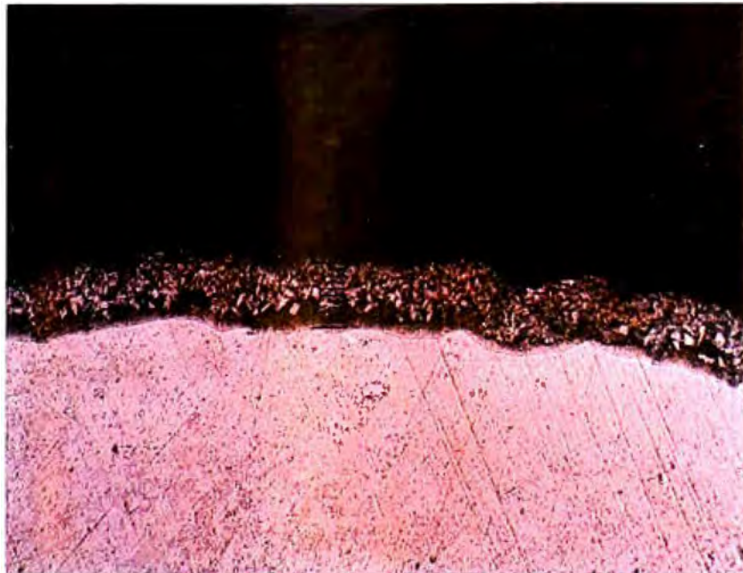
Foto N° 16: Metalografía de un grillete de acero galvanizado 1000 g/m 2 # 340-0-2 50X Scale : 0.2 mm Metalografía mostrando la copa de zinc con una medida de espesor de 8.0 mils
