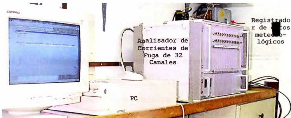
Fig.2: Registro de Corrientes de Fuga de 32 Canales situados en la Estación de Pruebas.
