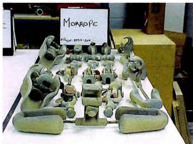
Foto N° 15: Muestras de ferretería de línea usado para las pruebas de corrosión Chimbote – L-215, T-25, 26 & 27 Morrope – Estación de pruebas Test station L-238, T-128 Muestra de alto nivel de contaminación en la estación de pruebas
