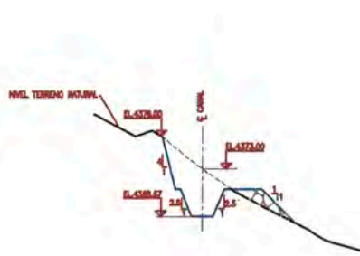
DETALLE TÍPICO CANAL CON CORTE Y RELLENO
