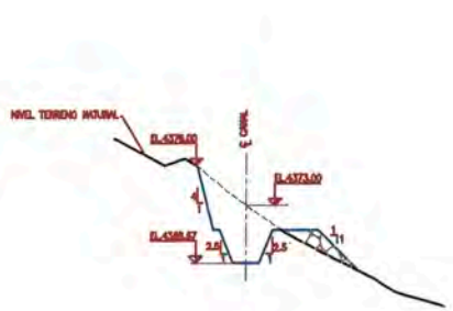
DETALLE TÍPICO CANAL CON CORTE Y RELLENO
