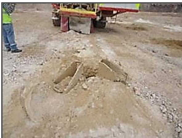
**FIGURA 17:** Bandejas de muestreo con la muestra recolectada
