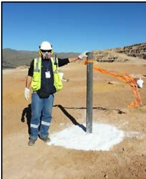
**FIGURA 58:** Tubería con la cual se medirá el desplazamiento de carga por Voladura
