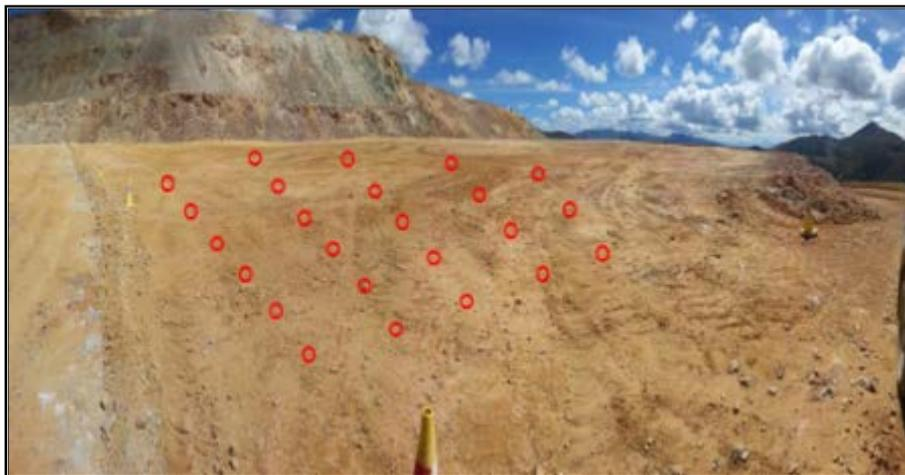
**FIGURA 16:** Identificación de la malla de perforación, 5.5m x 5.5m en SD
