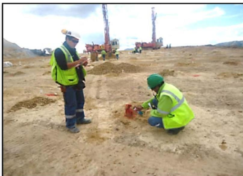
**FIGURA 55:** Ubicación de puntos intermedios para prueba de desplazamiento de carga por voladura
