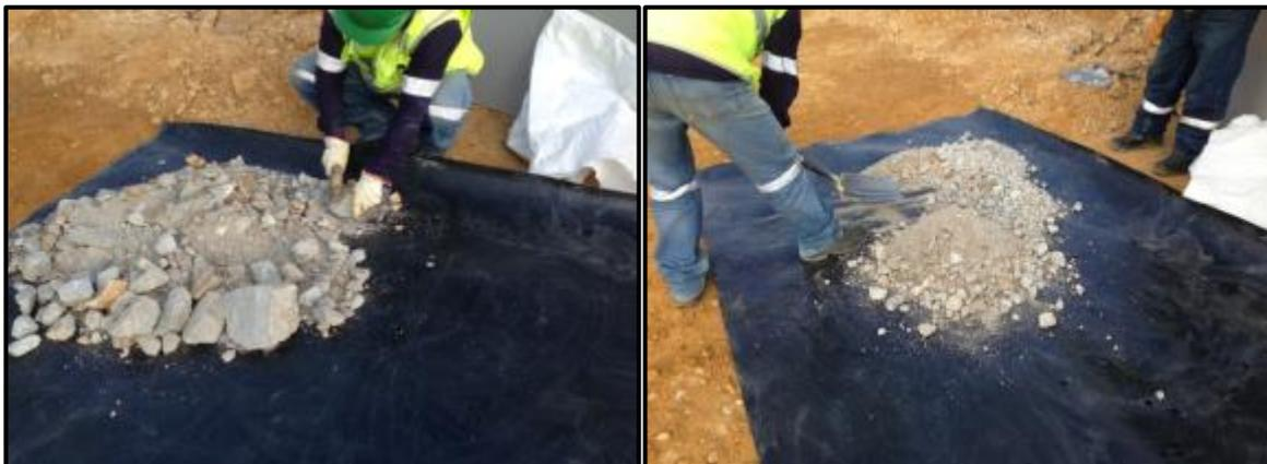
**FIGURA 26:** Chancado de la muestra (izquierda), Homogenización de la muestra (derecha)
