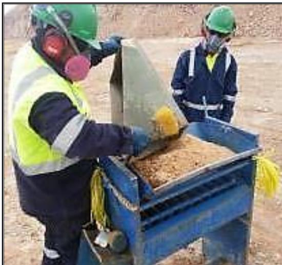
**FIGURA 20:** Material colocado en el divisor de muestra
