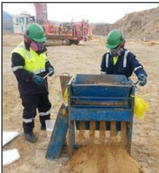
**FIGURA 21:** Reducción de la muestra, se obtiene entre 4-5kg, que será enviada para su análisis
