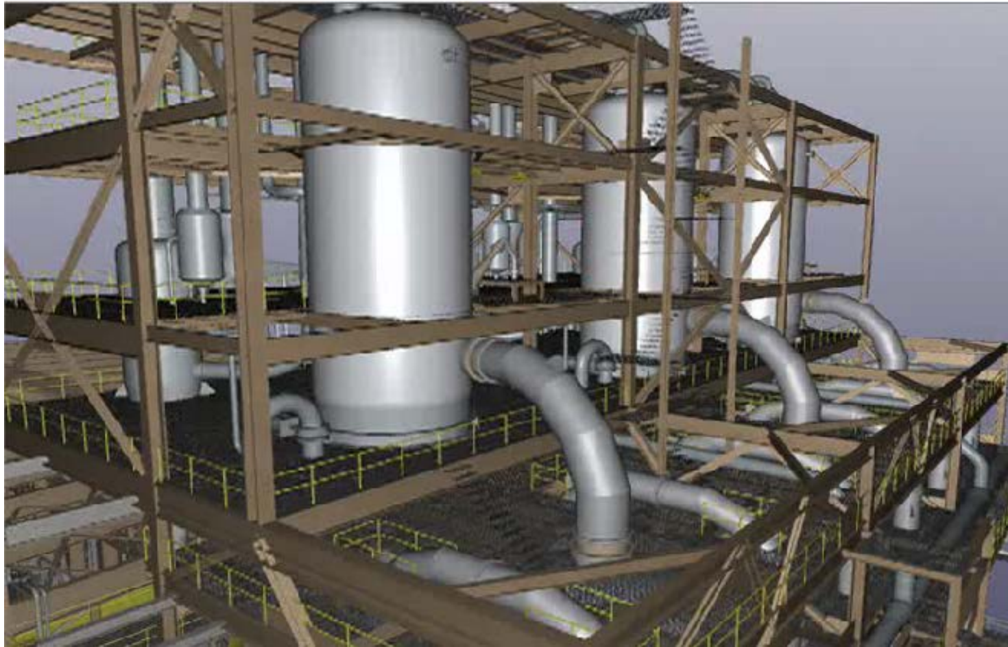
Figura Nº 5.12.- Autoclave quench vessels
