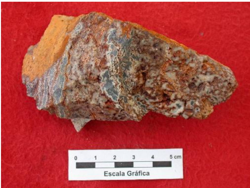
FOTO N° 9 : Brecha hidrotermal, obsérvese las inyecciones de sílice con sulfuros, matriz de óxidos con alunita.
