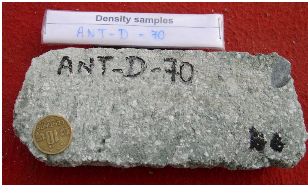
FOTO N° 6 : Unidad Andesita Superior, la roca presenta textura porfirítica, con esporádicos fragmentos heterolíticos.
