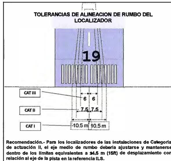
Fig. 2.30 Tolerancia de alineación del rumbo según la categoría.
