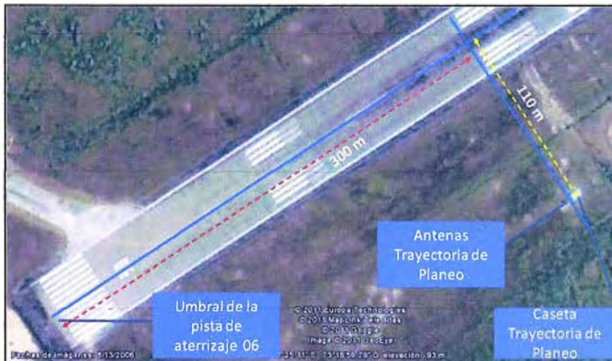
Fig. 3.2. Ubicación Trayectoria de Planeo – Iquitos (Imagen obtenida mediante Google Earth)
