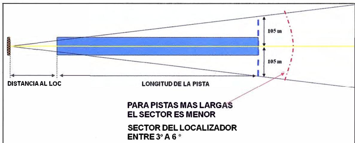
Fig. 3.9 Datos requeridos en el cálculo del ancho del sector. (Fuente: Elaboración propia)
