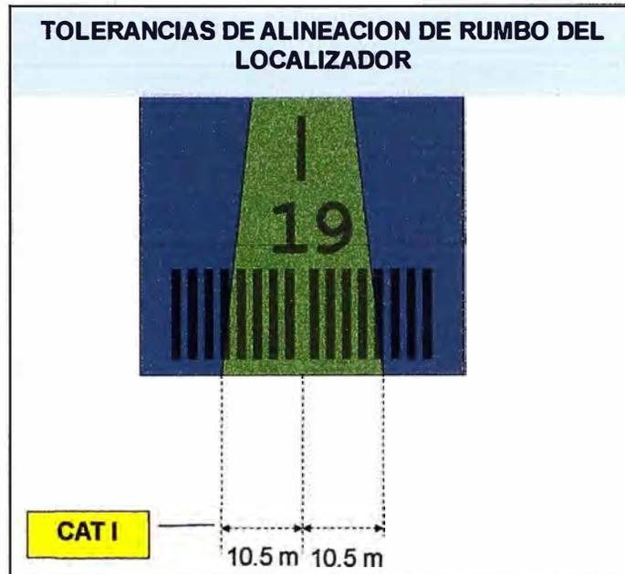
Fig. 3.29 Ajuste de alarma para el alineamiento del Curso. (Elaboración propia).
