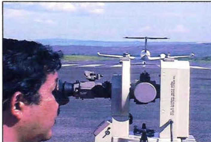
Fig. 3.21 Verificaciones del alineamiento de la aeronave, sobre el eje de pista.
