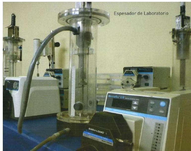
**Figura 5.4:** Espesador Dinámico de Laboratorio Outotec Supaflo<sup>®</sup> 99mm
