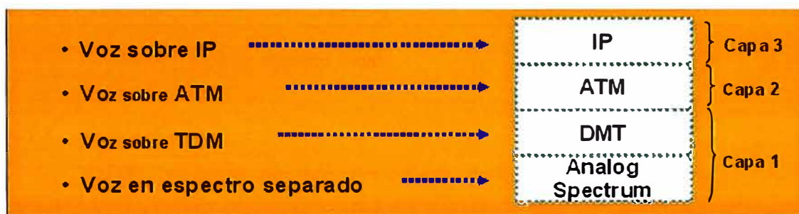
Fig. 4.2 Diferentes aplicaciones de voz por conmutación de paquetes
