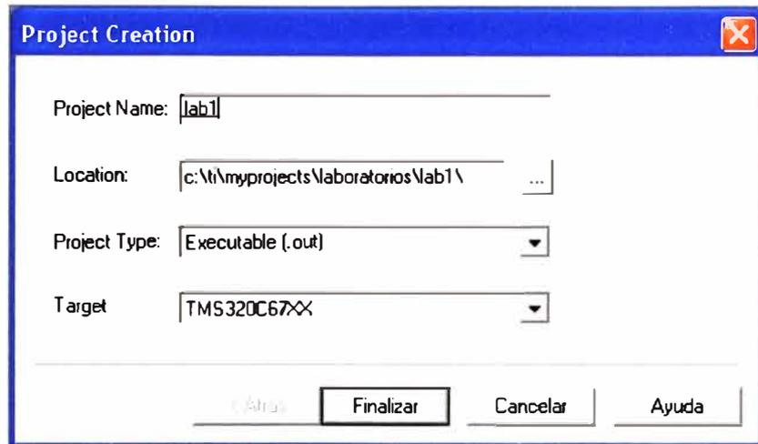
Fig. 7.12 Creación de un proyecto en el Code Composer Studio.
