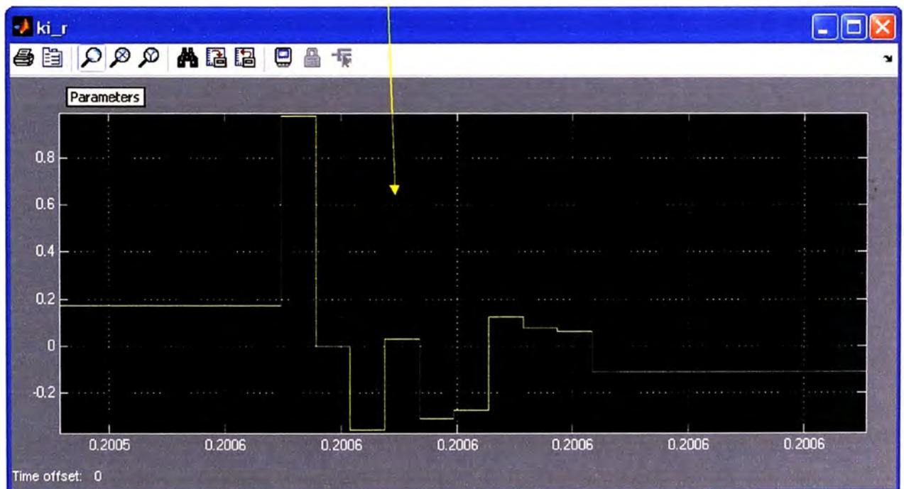
Fig. 6.32 Valores de los 10 coeficientes LPC (RC) ampliados para una trama.
