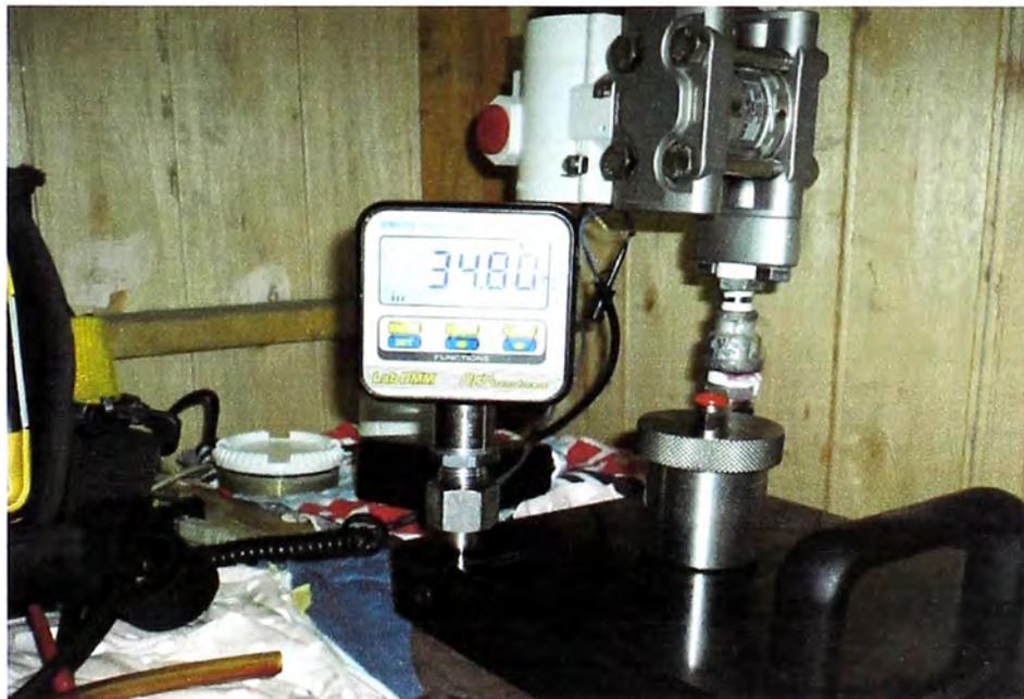
CALIBRADOR DE PRESIÓN CON PEDESTAL.
