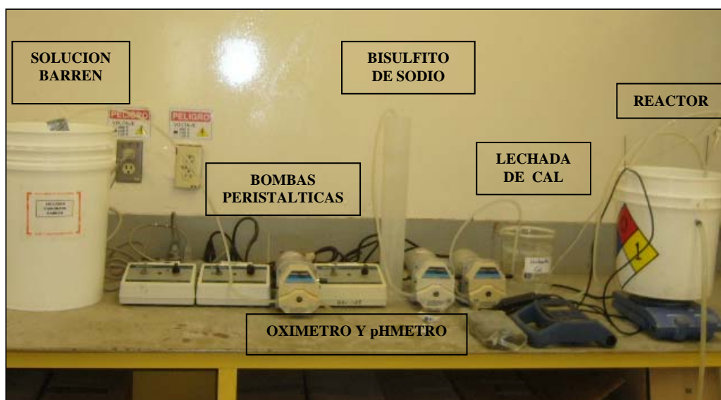
Fig 3.1.2.1 – Sistema de Destrucción en Línea para Pruebas en Laboratorio
