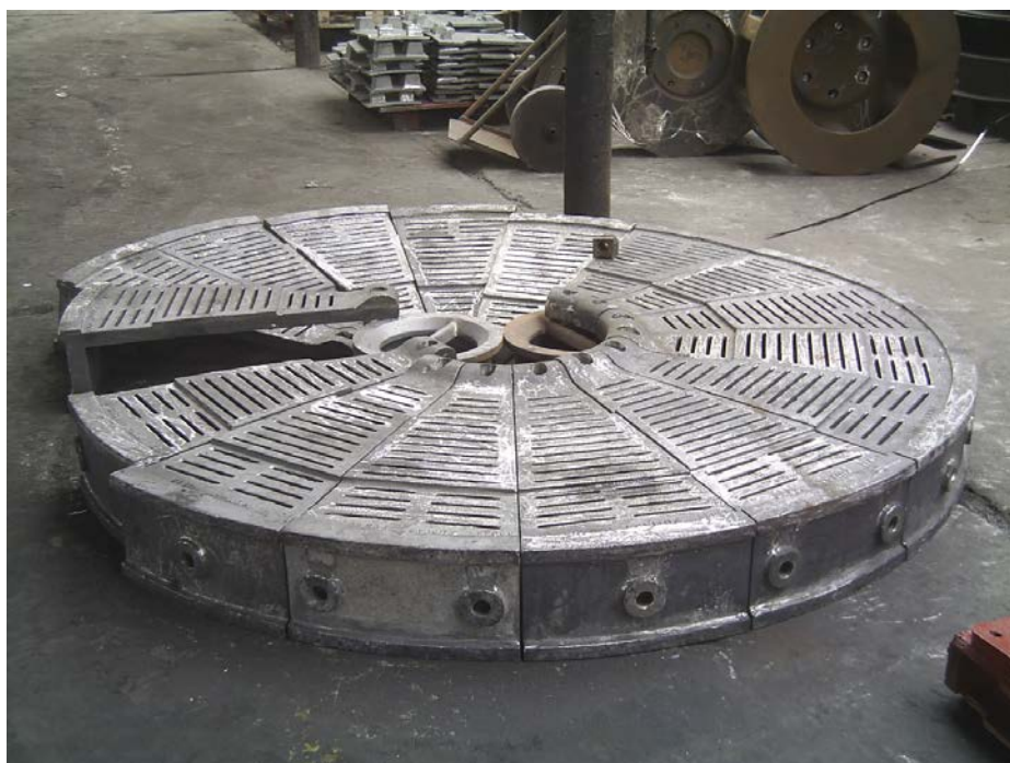
Figura 3.22b: Placas de Pared Intermedia ó Diafragma de Molino
