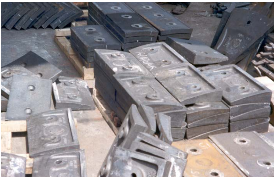
Figura 3.21: Forros de 1ra Cámara de Molino
