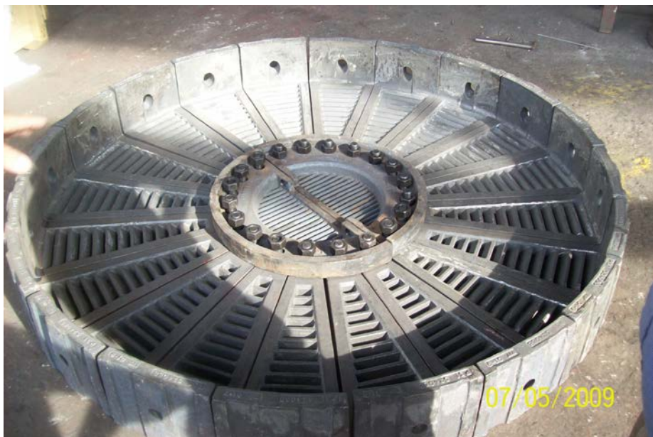
Figura 3.22a: Placas de Pared Intermedia ó Diafragma de Molino
