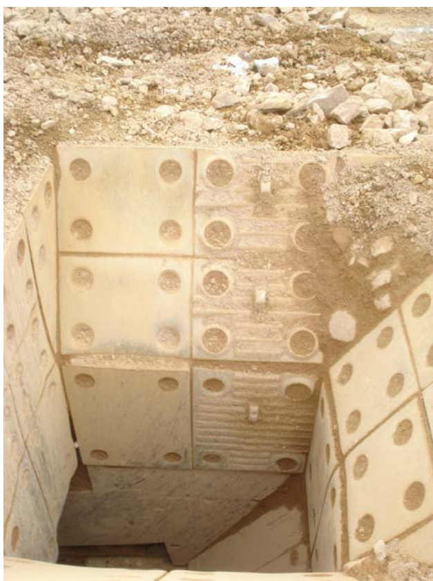
Fig. 5.17: Liners de Stock Pile en operación
