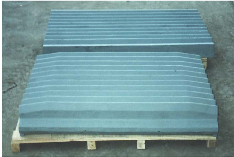
Figura 3.2: Mandíbulas Fija y Móvil
