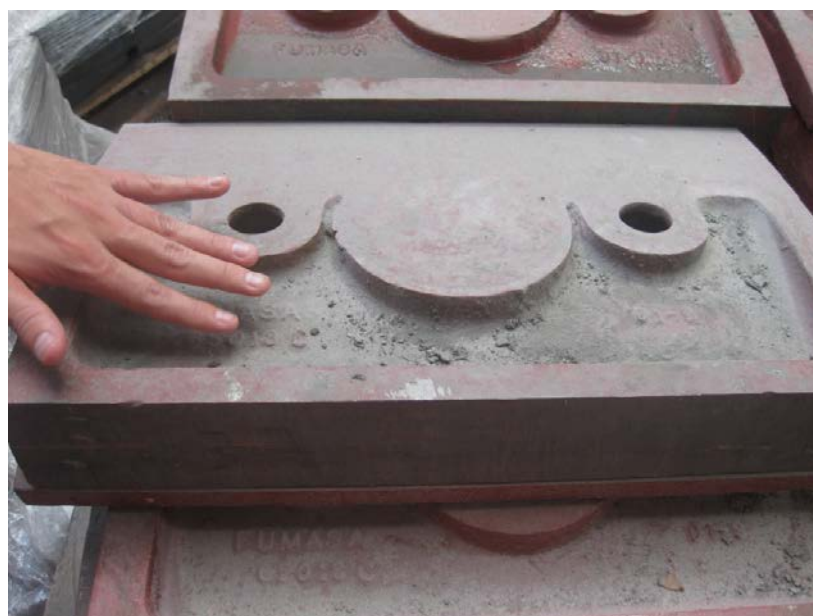
Figura 5.8: Placa Primera Cámara Molino nueva – Cara lado casco
