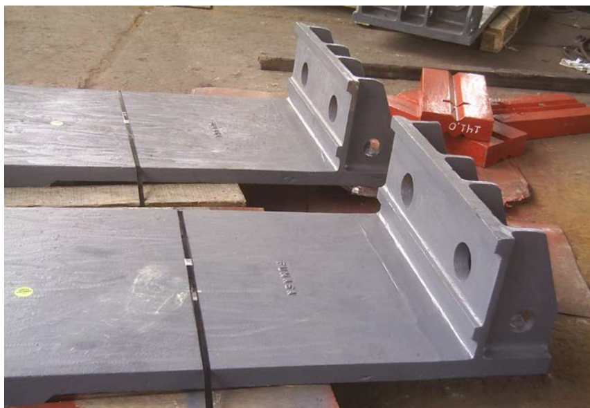
Figura 3.13: Revestimientos de Tolvas de almacenamiento
