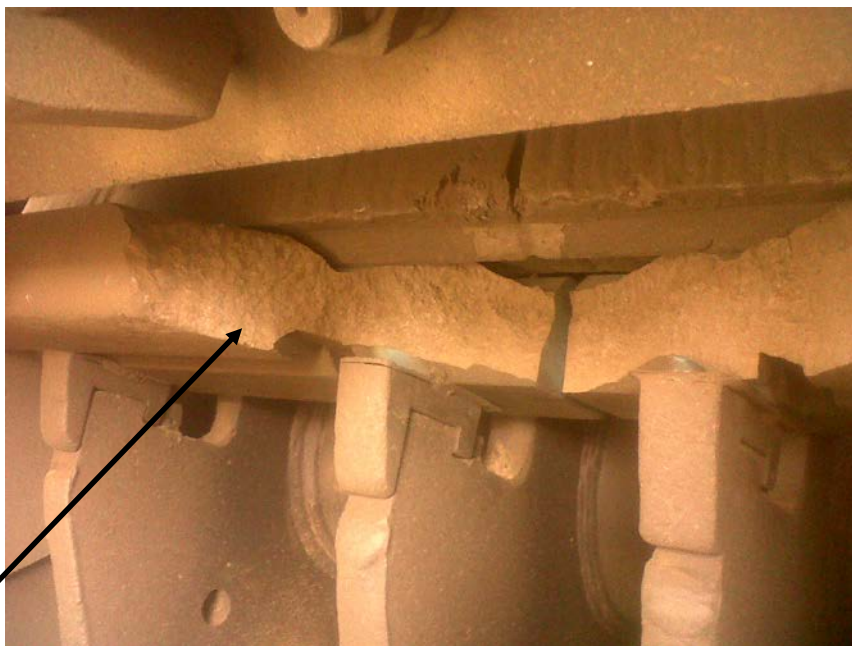
Figura 5.3: Barra Batidora instalada
