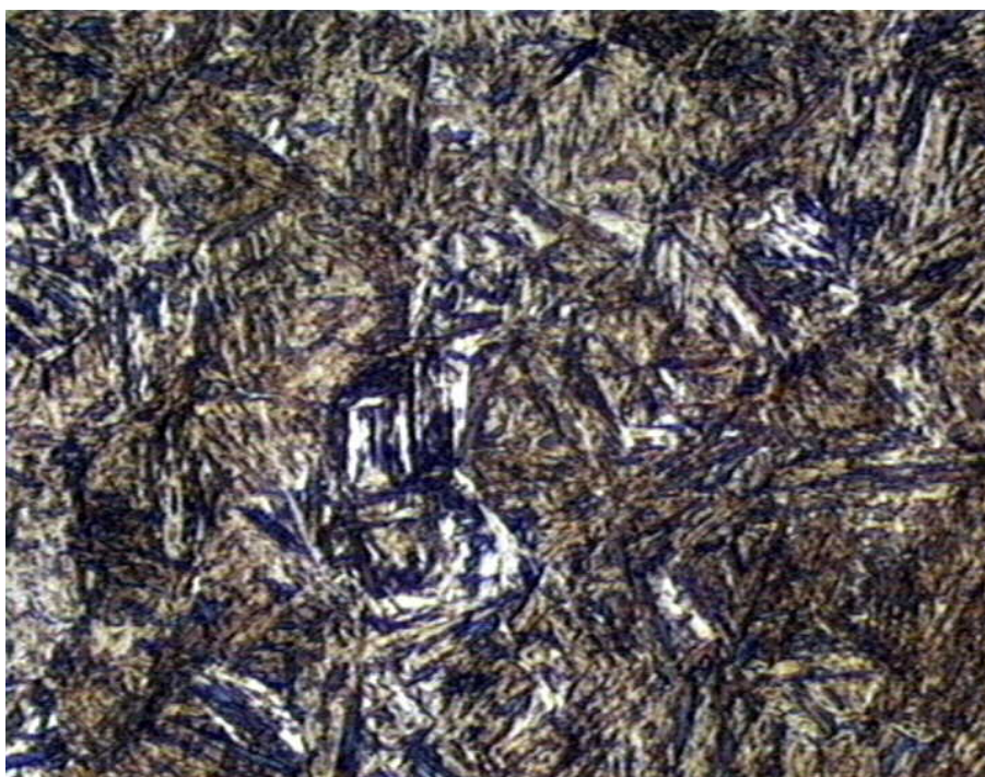
Figura 3.7: Estructura Martensítica Revenida
