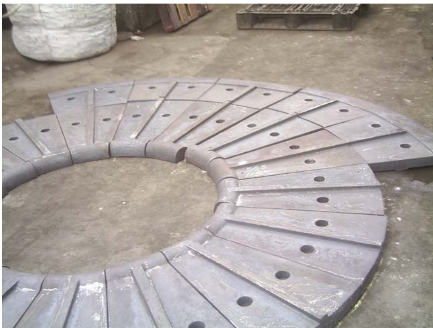
Figura 3.20 : Placas de Pared de Entrada de Molino de Crudo
