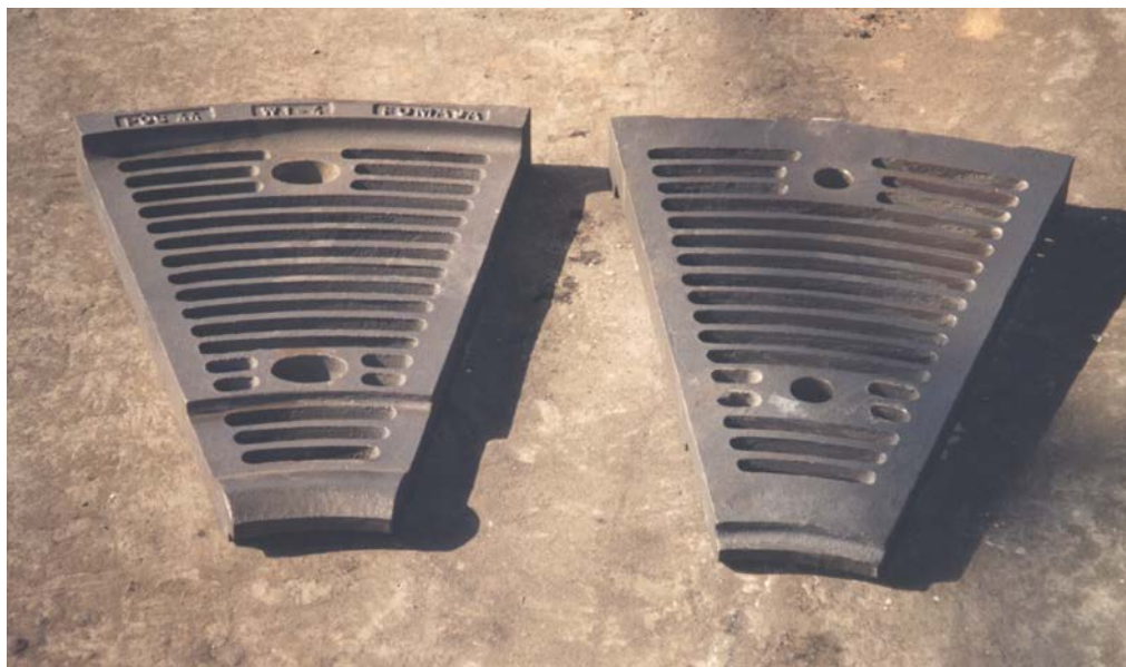
Figura 3.24: Placas Ranuradas de Pared de Salida de Molino de Crudo/Cemento
