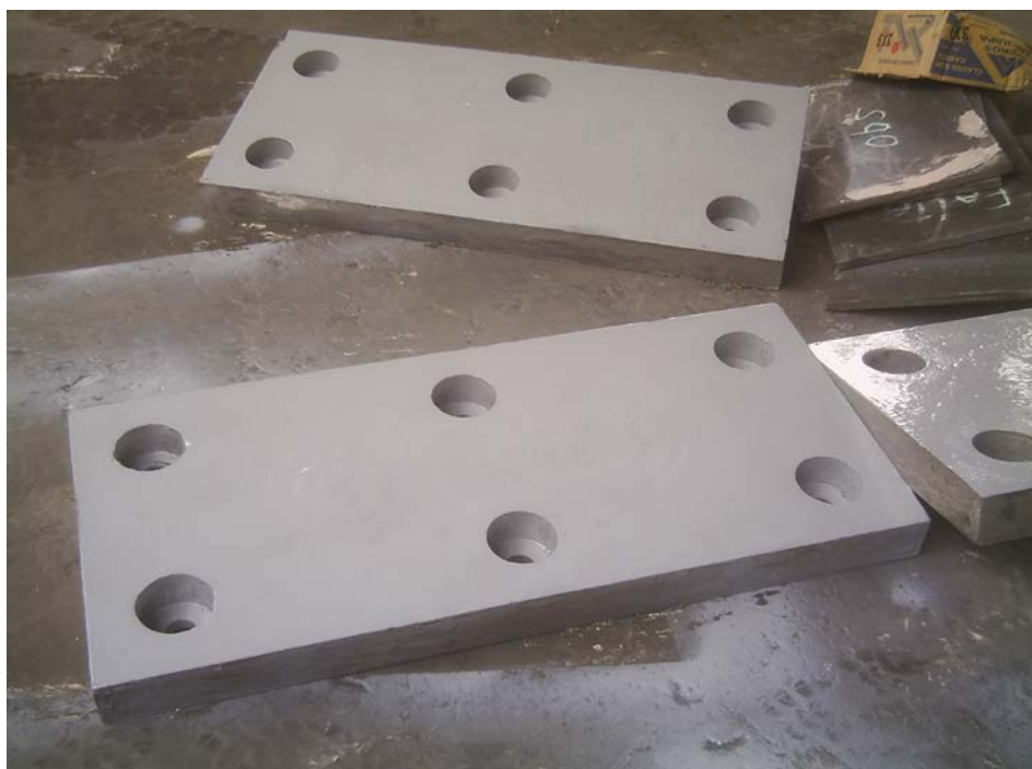
Figura 3.27: Liner protectores de Tolvas
