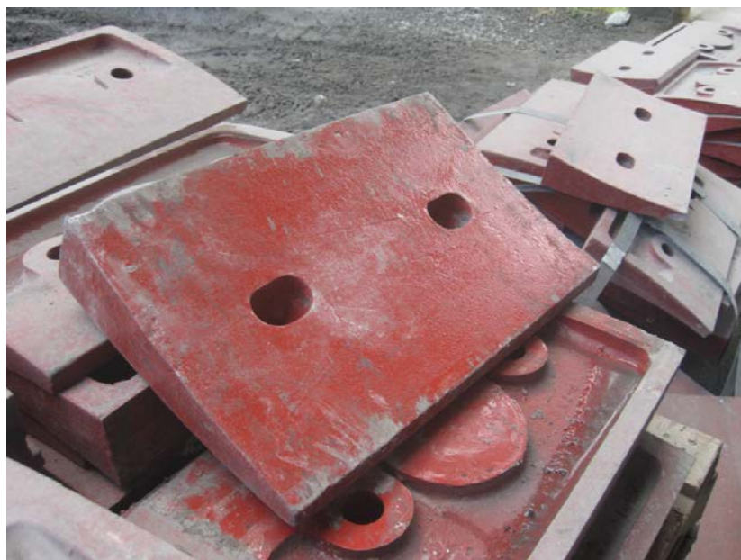
Figura 5.7: Placa Primera Cámara Molino nueva – Cara de Trabajo
