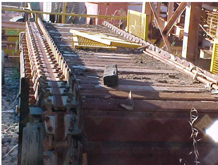
Figura 3.4: Bandejas de Apron Feeder (Alimentadores)
