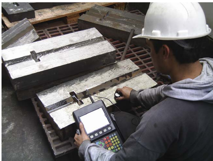
Figura. 5.2: Ensayos No Destructivos en Barra Batidora fundida
