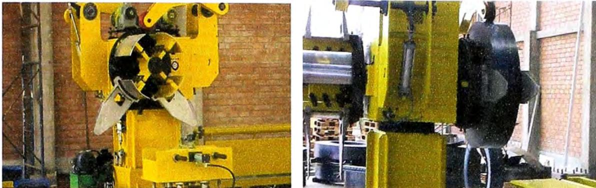
**Fig. 3.9** Desbobinador
