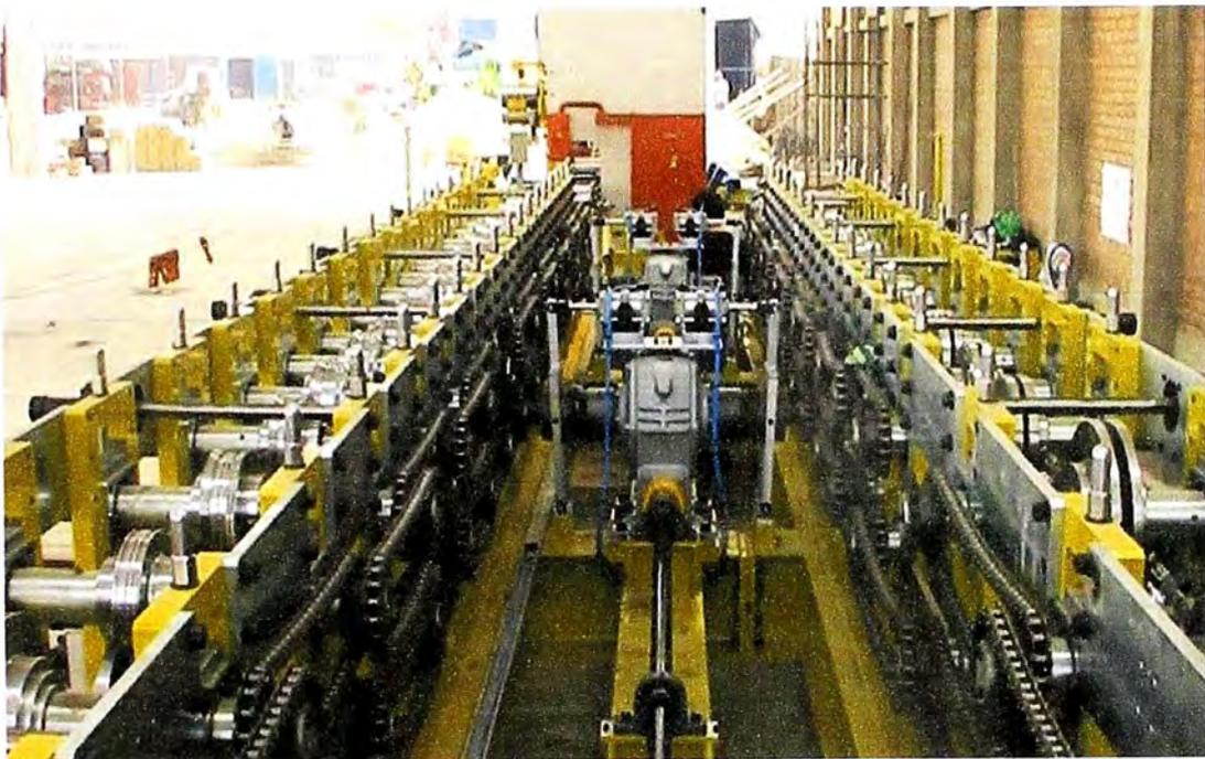
**Fig. 3.5** Sistema Roll Forming para Racks y Vigas
