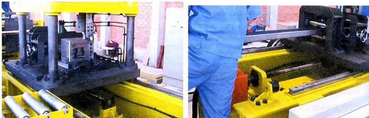
**Fig. 3.13** Prensa de Corte
