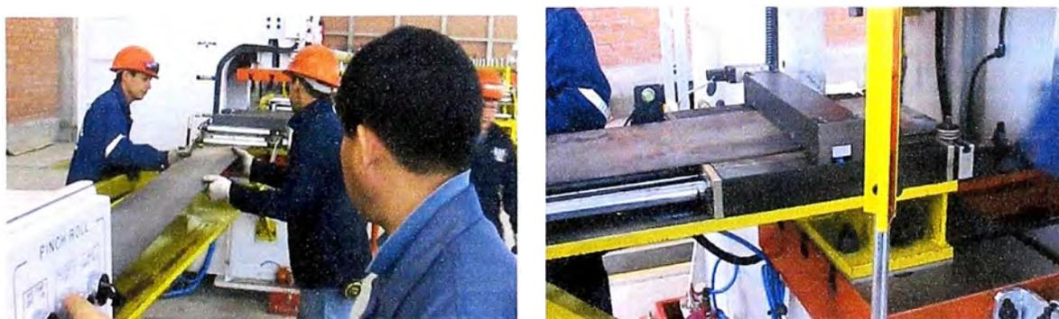
**Fig. 4.5** El fleje ingresa a la prensa mecánica
