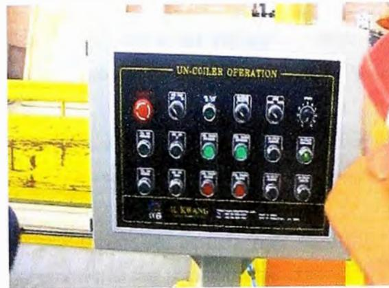
**Fig. 4.28** Panel Principal y Panel del Desbobinador
