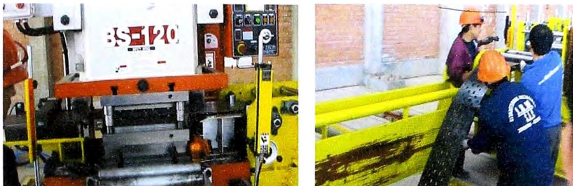
Fig. 4.6 La prensa hace los huecos y alimenta a los rodillos
