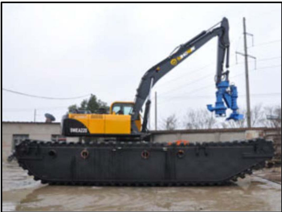
Figura 5.3 Bomba draga montada sobre excavadora hidráulica anfibia
