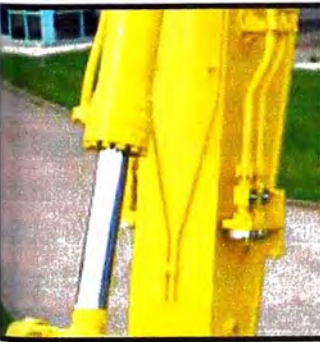
Circuitos hidráulicos para enganche rápido (estándar)
