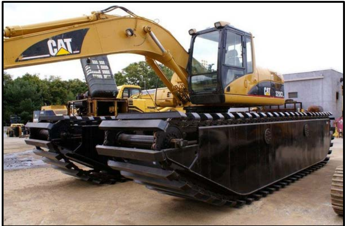
Figura 4.5 Excavadora hidráulica CAT 320 anfibia
