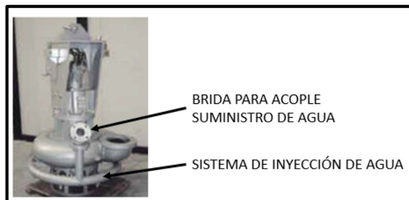
Figura 4.1 Bomba draga con brazos excavadores y agitador de lodos
