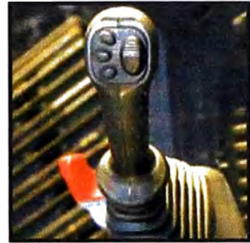
Joysticks con botón de control proporcional para los implementos
