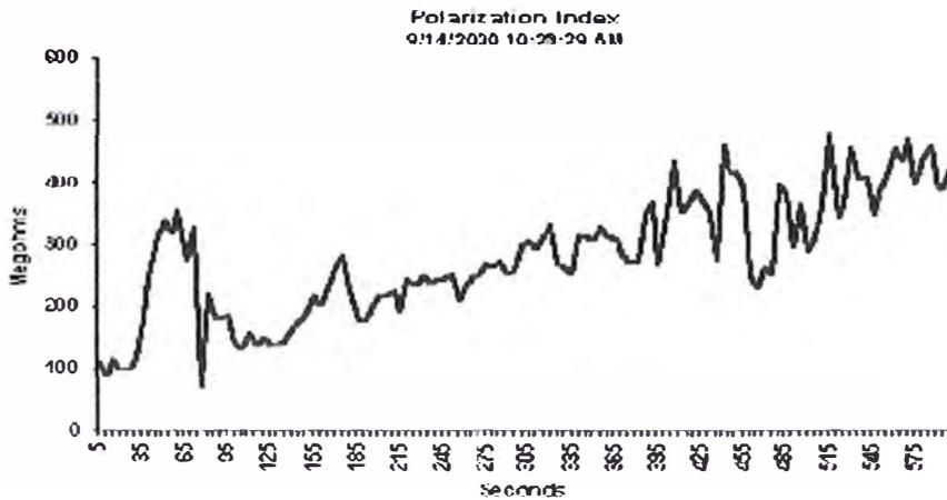
**Fig.2.18** Perfil del índice de polarización inaceptable
