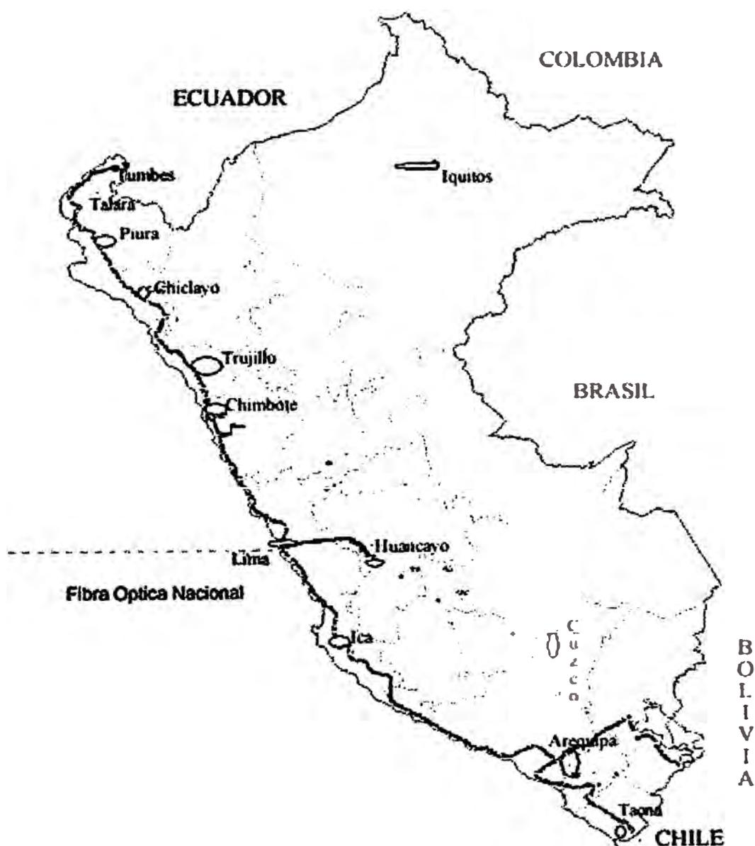
**Figura 3.1:** Esquemático de red de larga distancia Óptica Terrestre – Telefónica del Perú
