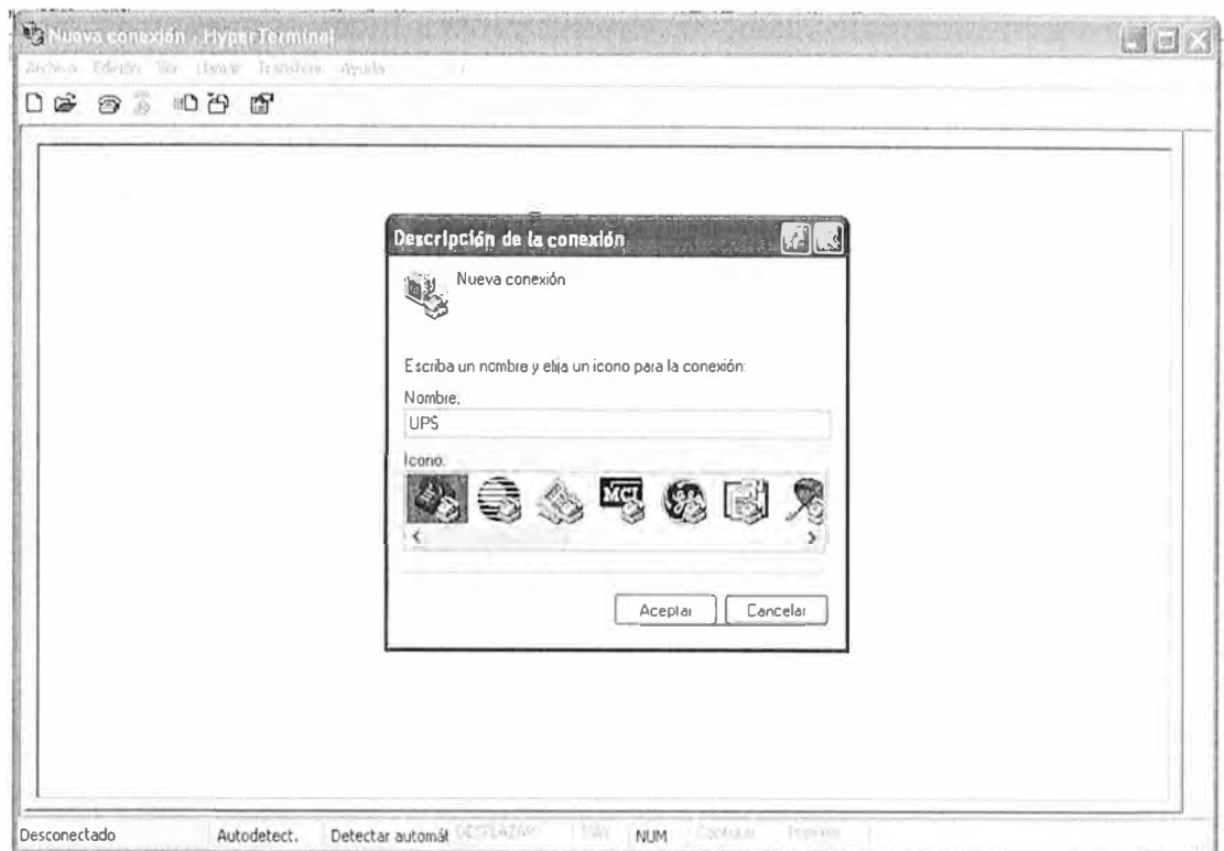
Figura 2.3: Gráfico de conexión al equipo de conexión a red del UPS marca Chloride
