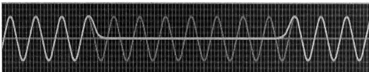
Figura 1.5; Forma de Onda de la Interrupciones de Energía
