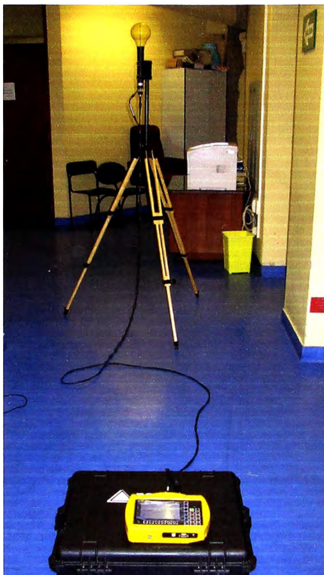
Figura 6.1 Medidor de Radiaciones Selectivo en Frecuencia, marca Narda, modelo SRM-3000
