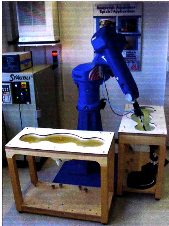
Figura 5.3 Fotografía del Sistema de medida - Brazo robótico
