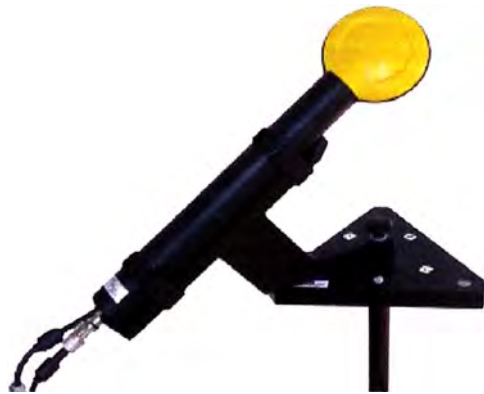
Figura 6.3 Antena de un solo eje para campo Magnético
