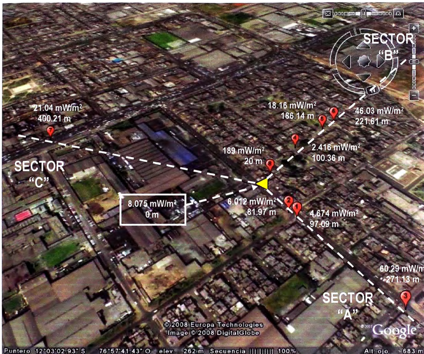
Figura 6.16 Ubicación de la estación Base y de algunos puntos de medición con los valores más resaltantes
