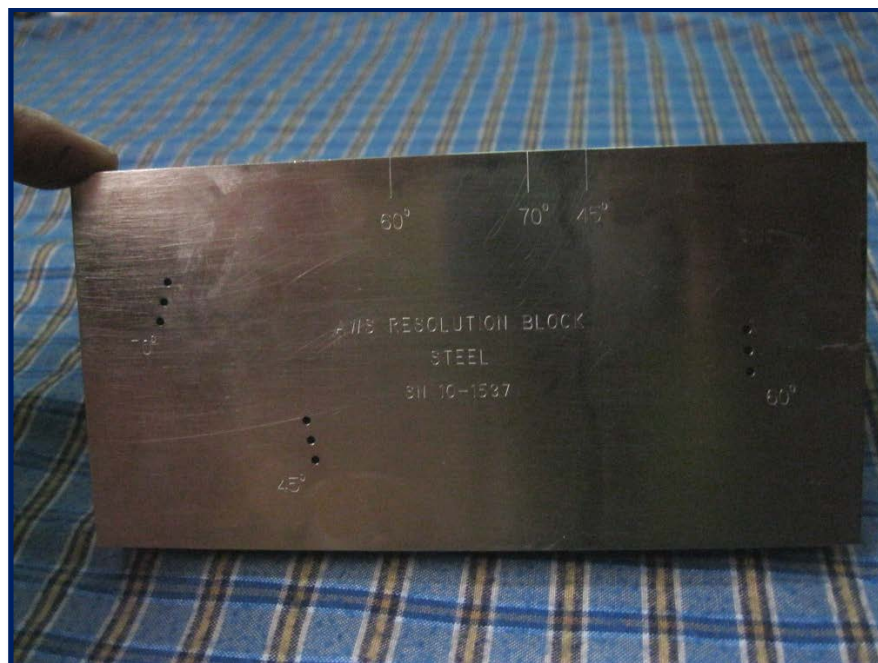
Fotografía 4. Patrón de calibración RC – Resolución - según AWS D1.1
