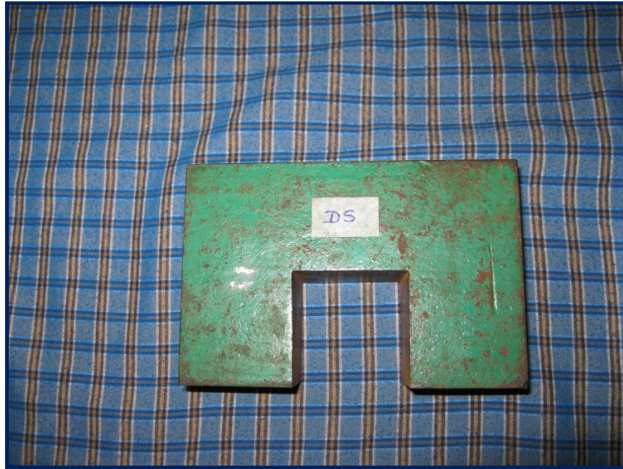
Fotografía 3. Patrón de calibración DS según AWS D1.1
