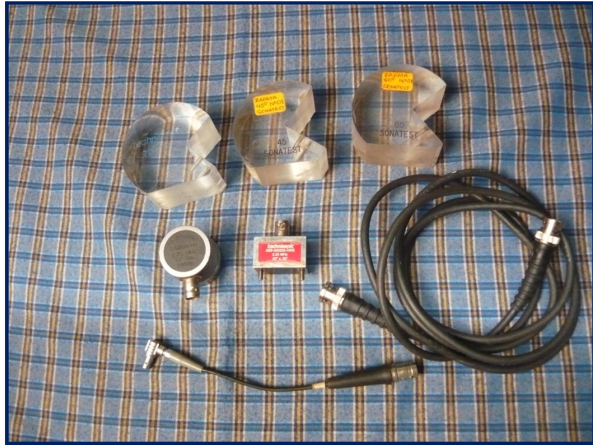
Fotografía 1. Cable coaxial, transductores circular y rectangular y zapatas
