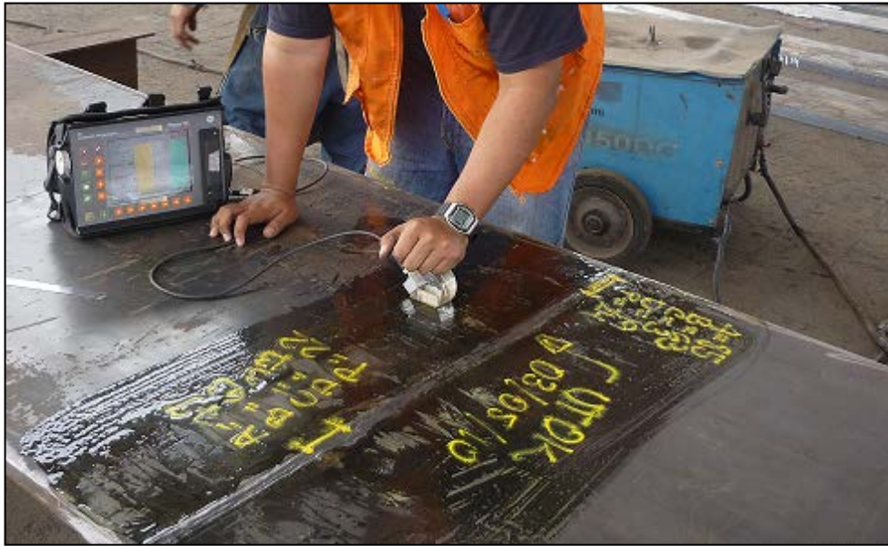
Figura 4.4 Marcaje del resultado final después de la inspección de una unión soldada.
