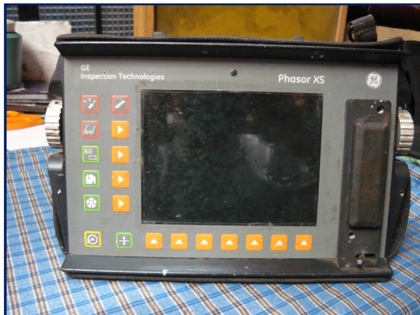
Fotografía 2. Equipo de ultrasonido PHASOR XS S/N 01W1PV.
