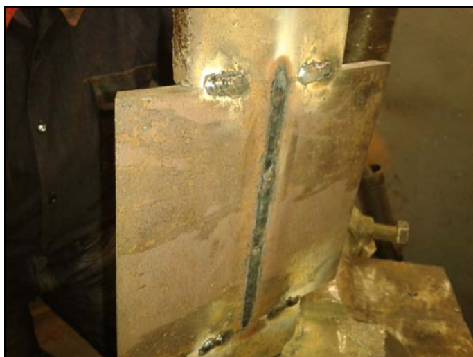
Figura 2.9: Raíz aceptada visualmente – parte1
