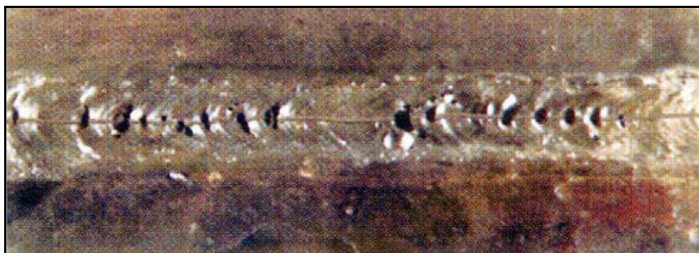
Figura 1.15: Discontinuidades - Poros superficiales alineados unidos por una fisura longitudinal (fuente, Welding Inspection Tecnology – 5ta edición)
