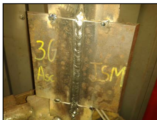
Figura 2.13: Acabado aceptado visualmente – parte1
