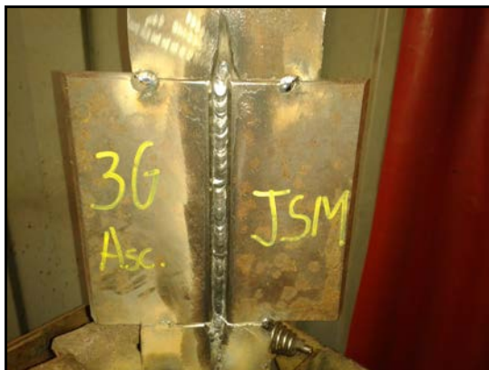
Figura 2.11: Relleno aceptado visualmente
