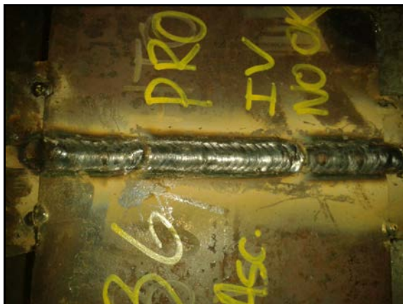
Figura 2.35: Defectos - Soldador PRO malos empalmes – parte1
