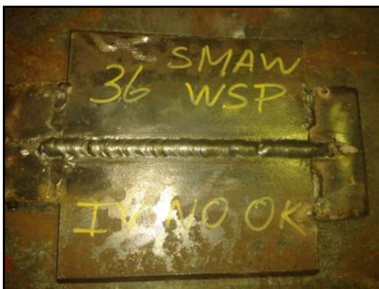
Figura 2.39: Defectos - Soldador WSP, acabado irregular – parte1
