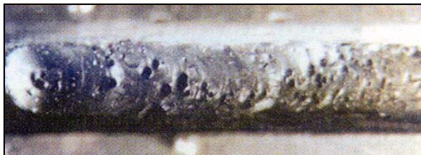
Figura 1.14: Discontinuidades - Poros distribuidos uniformemente (fuente, Welding Inspection Technology – 5ta edición)
