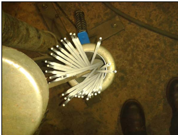
Figura 2.17: Horno de almacenamiento de electrodos E7018 – parte2
