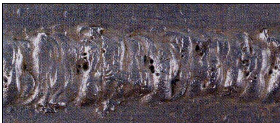
Figura 1.16: Discontinuidades - Poros superficiales aislados (fuente, Welding Inspection Tecnology – 5ta edición)
