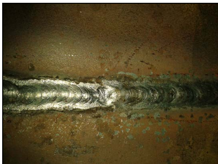
Figura 2.10: Raíz aceptada visualmente – parte2
