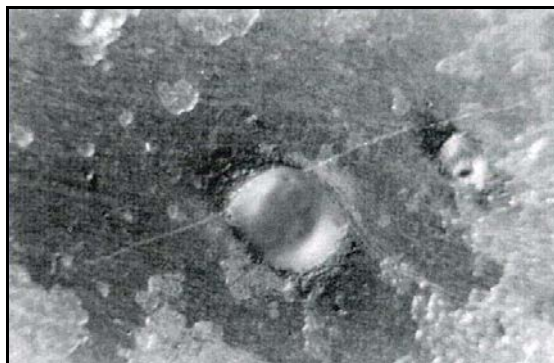
Figura 1.25: Discontinuidades - Fisura formada en una salpicadura en la superficie del metal base (fuente, Welding Inspection Technology – 5ta edición)
