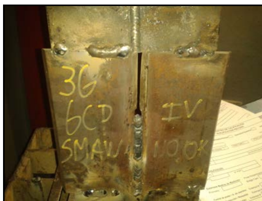
Figura 2.37: Defectos - Soldador GCP demasiada penetración en la raíz – parte1
