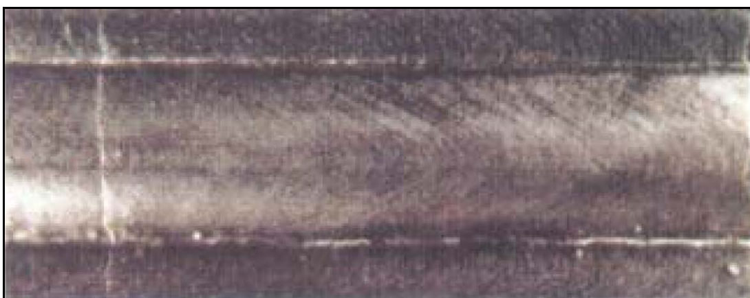
Figura 1.8: Discontinuidades - Fisura transversal (fuente, Welding Inspection Technology – 5ta edición)
