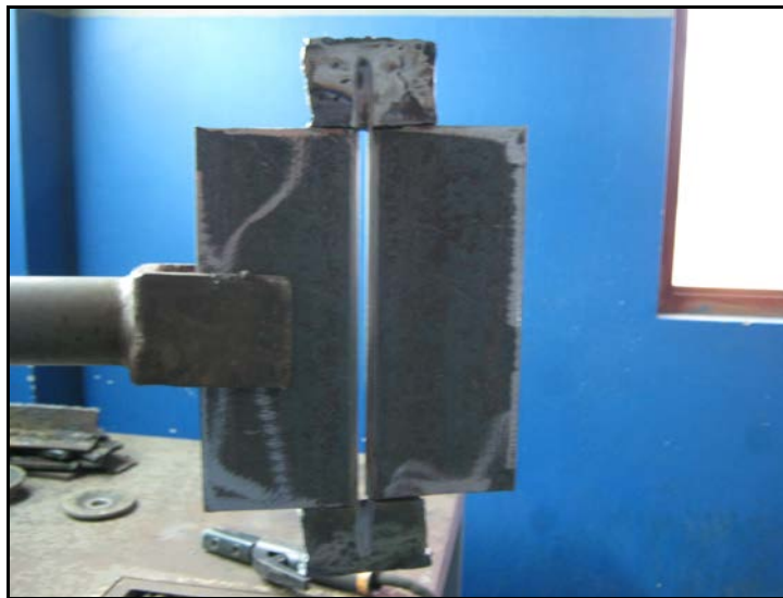
Figura 2.4: Cupón en posición vertical 3G
