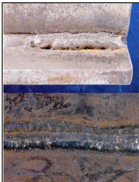
Figura 1.21: Discontinuidades - Solapado en soldaduras con bisel y de filete (fuente, Welding Inspection Tecnology – 5ta edición)
