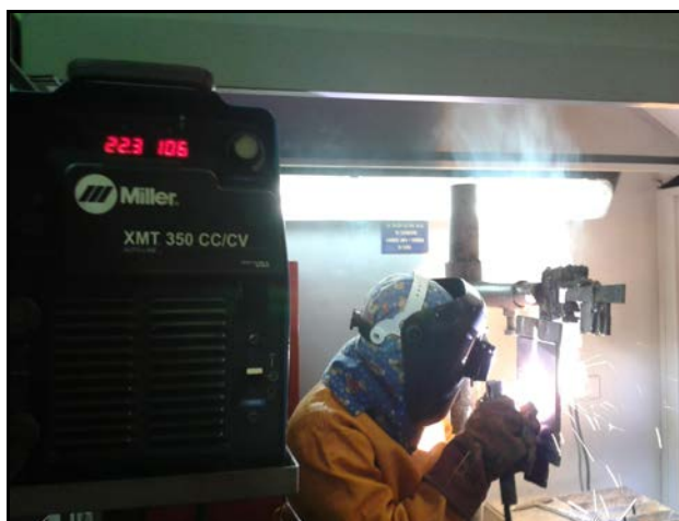
Figura 2.7: Soldadura del cupón en posición vertical – parte 2
