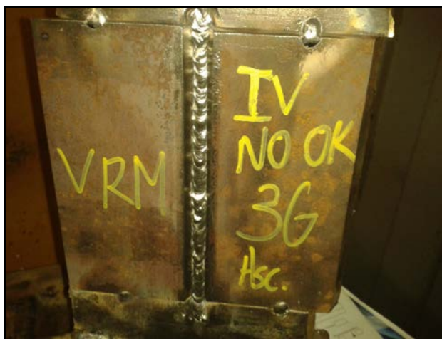
Figura 2.33: Defectos - Soldador VRM cordón irregular – parte1
