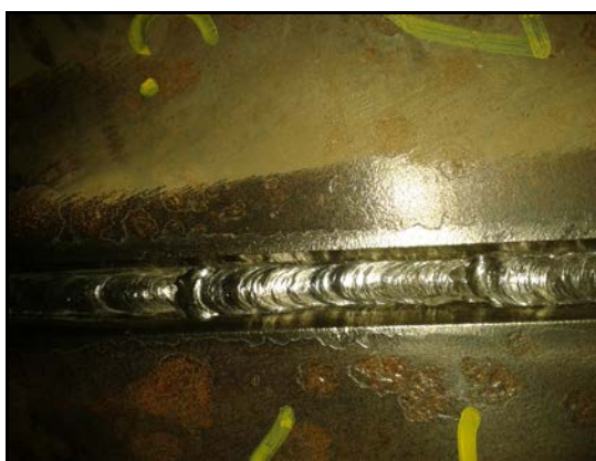
Figura 2.12: Detalle relleno aceptado visualmente
