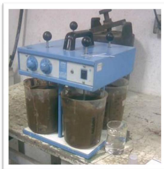
Foto N° 2: Equipo de Jarras para la destrucción de cianuro
