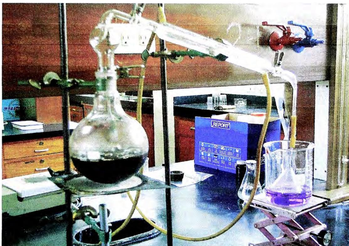
**Fig. 4.1. Determinación del contenido de Nitrógeno.**
