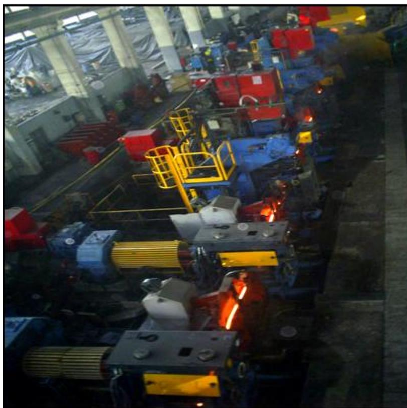
Figura N°1.29 Tren continuo de laminación.
