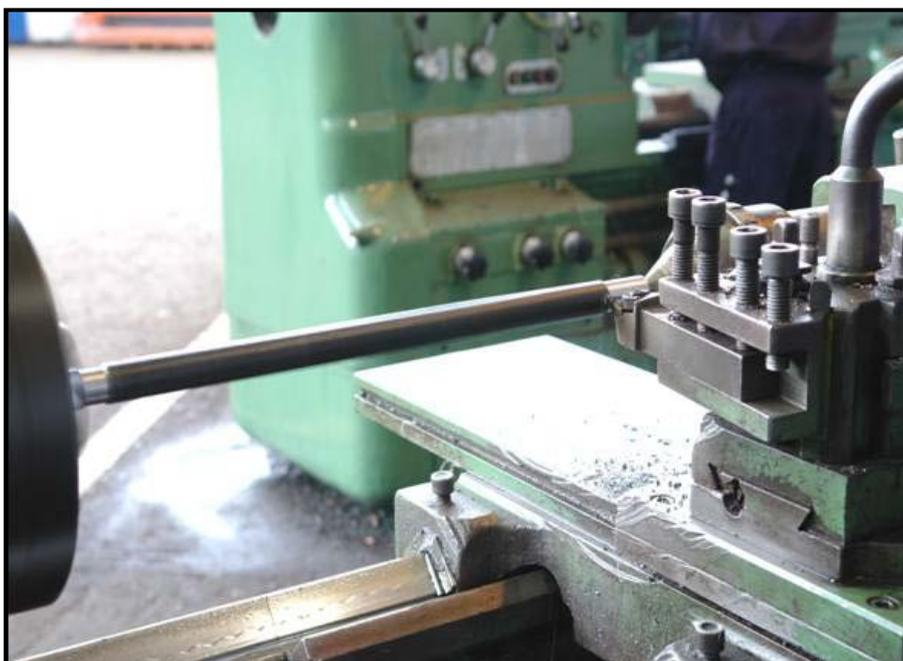
Figura N°1.42 Mecanizado en Torno Universal – Bajo ritmo de producción, (velocidades menores a los 400 rpm).
