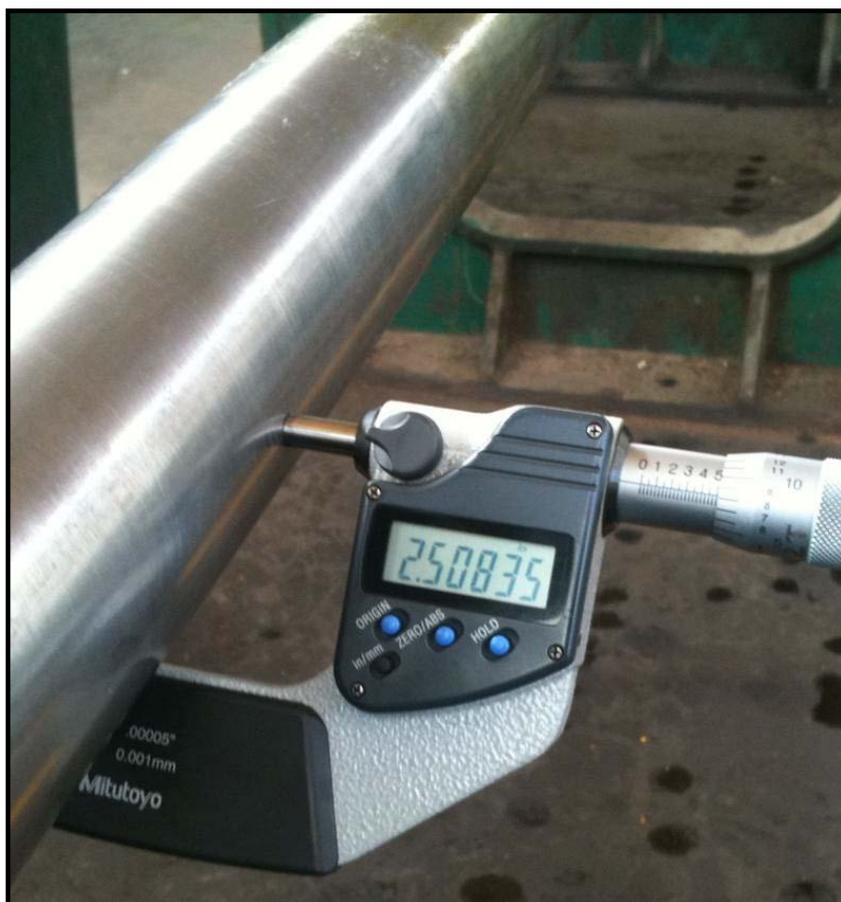
Figura N°1.41 Control Dimensional de las barras calibradas SAE 1018, tolerancias en diámetro según Norma ASTM A108 -07/ Norma ISO h11.
