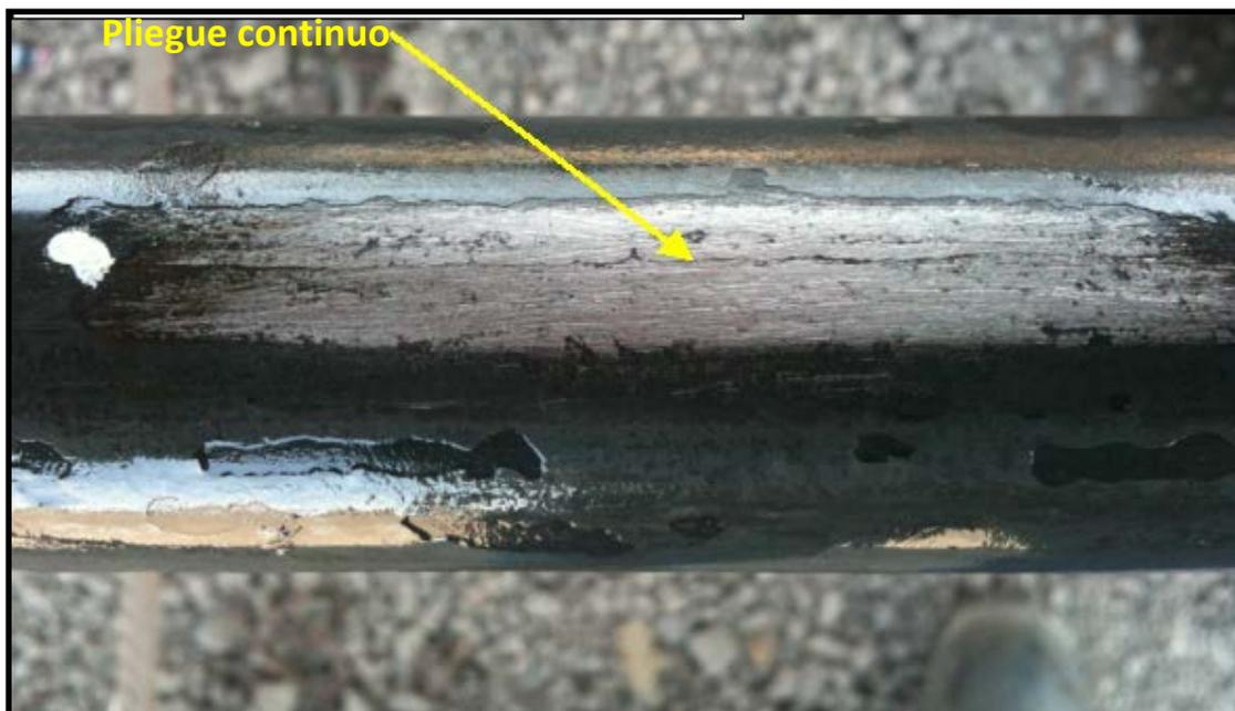
Figura N°3.25 Pliegue continuo detectado por ensayo de partículas magnéticas.
