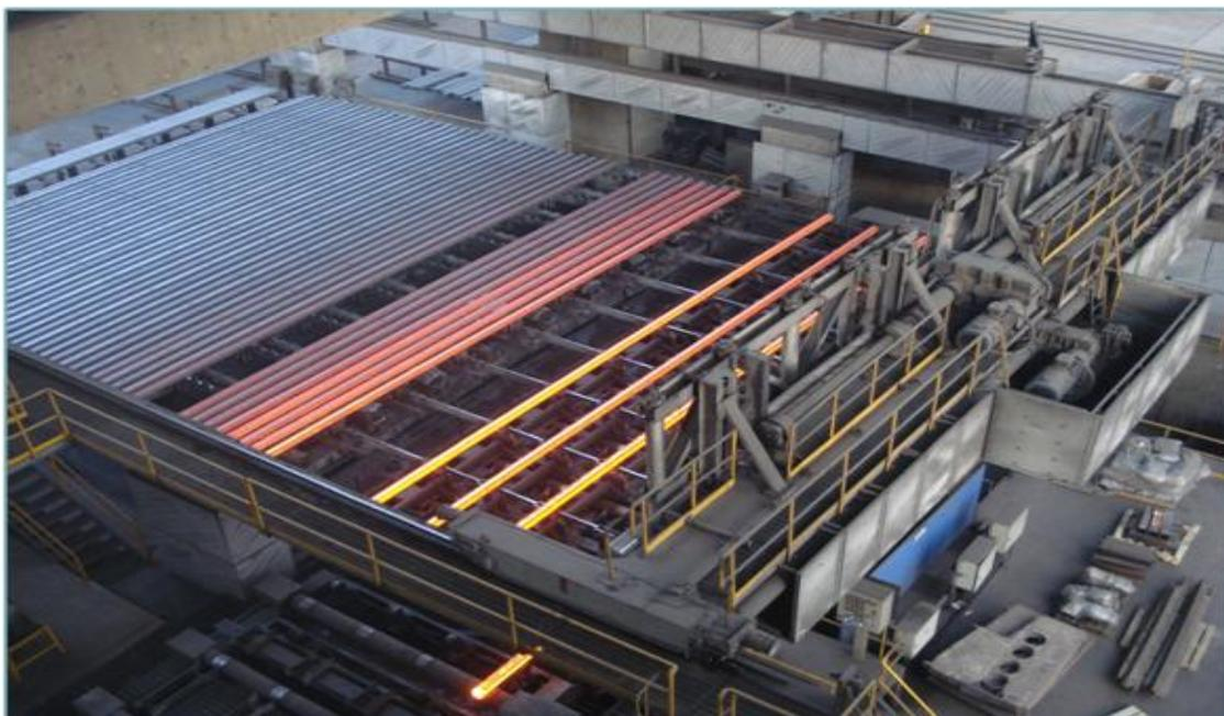
Figura N°1.23 Mesa de evacuación de palanquillas.
