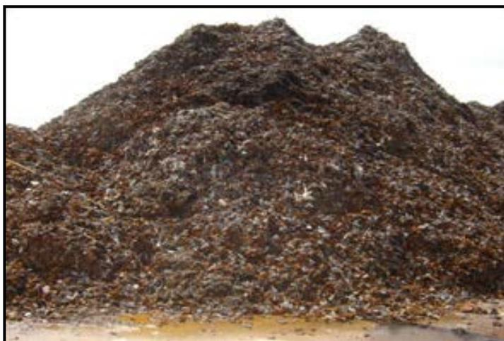
Figura N°1.5 Acero reciclado fragmentado.
