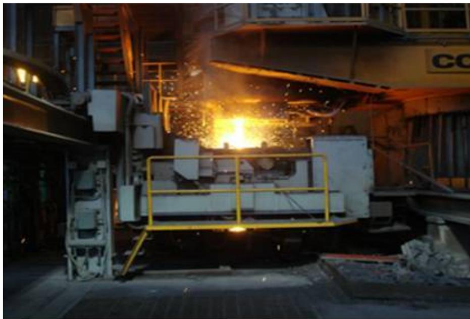
Figura N°1.18 Transferencia del acero líquido entre la cuchara – repartidor.
