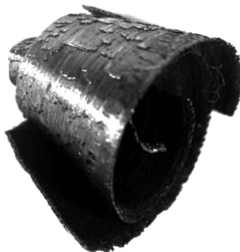
Figura N°2.19 Virutas de acero calidad DIN 9SMn28 (A y B). Se observa que las virutas presentan una superficie quebradiza y opaca.
