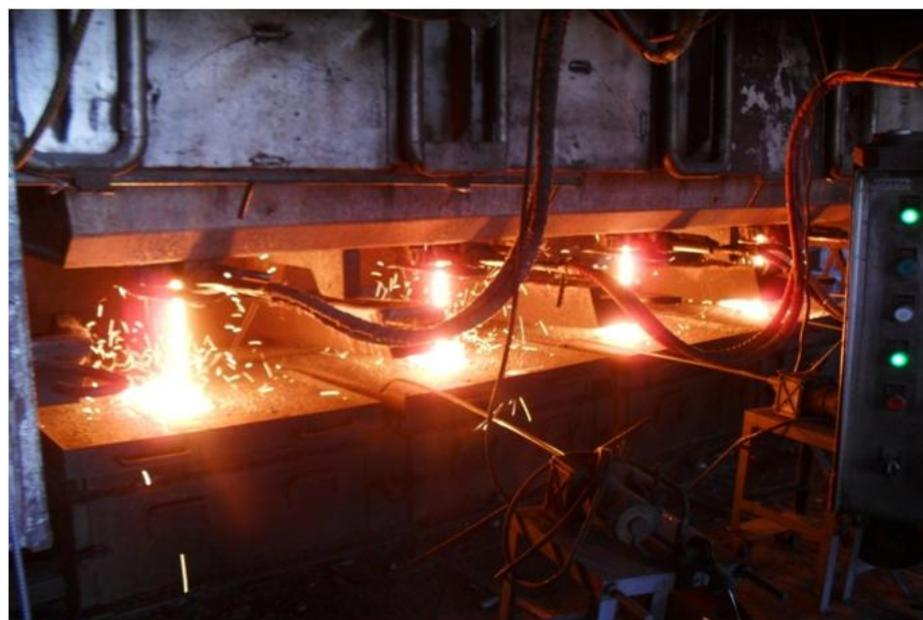
Figura N°1.19 Transferencia del acero líquido entre el repartidor – molde.
