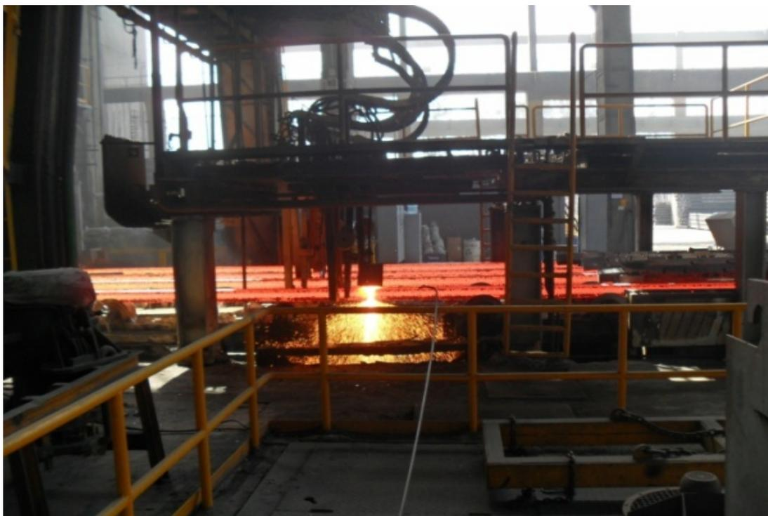
Figura N°1.22 Corte de palanquillas con equipo Rokop.
