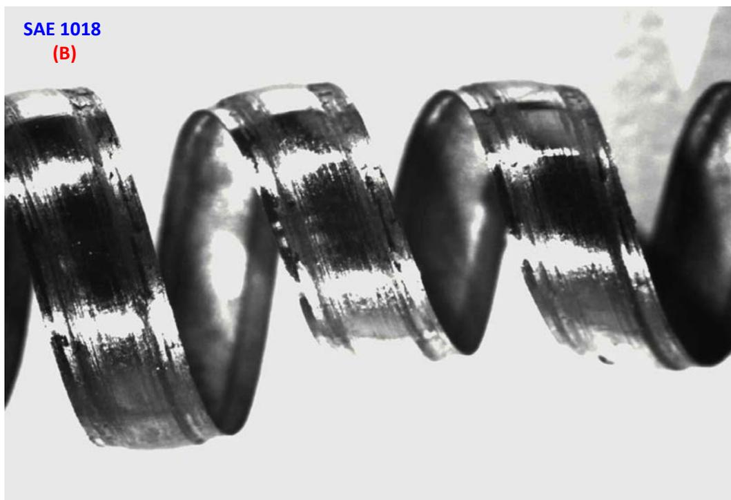
Figura N°2.20 La foto corresponde a viruta de acero calidad SAE 1018. Se puede observar que la viruta es lisa y de tono brillante.
