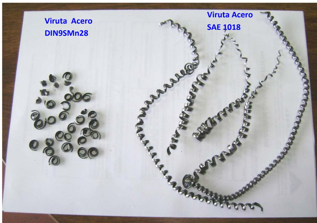
Figura N°2.18 Comparación de virutas del acero DIN9SMn28 y SAE 1018. Se observa que la viruta del acero DIN 9SMn28 es corta y de color opaco y la viruta del acero SAE 1018 es continua y brillante.
