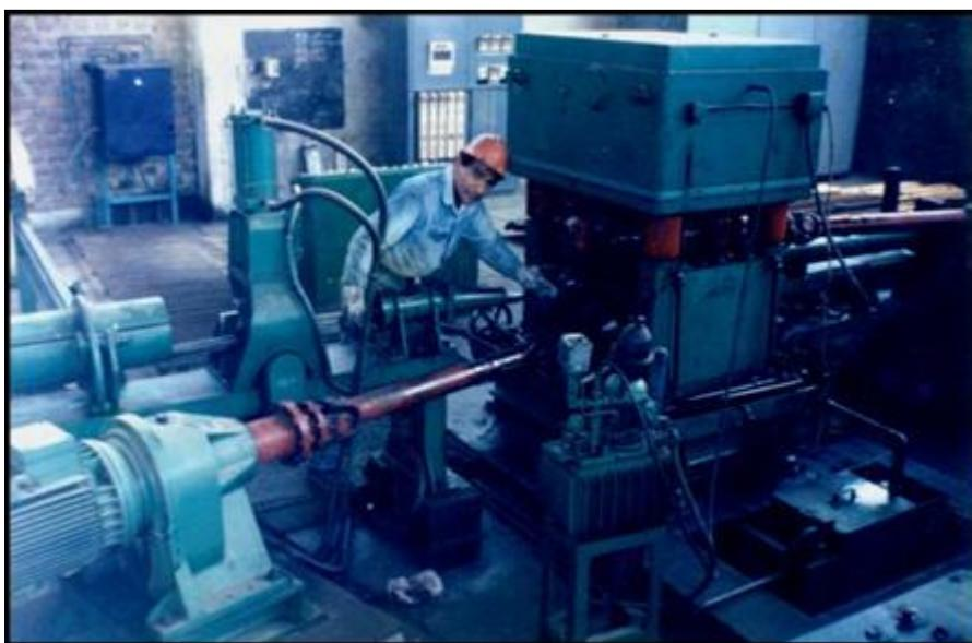
Figura N°1.40 Maquina Pulidora y Enderezadora de Barras Redondas Calibradas.
