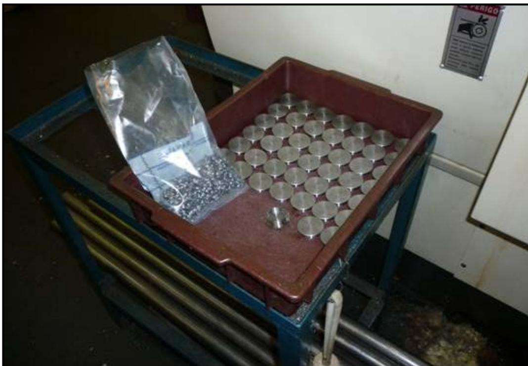
Figura N°2.17 Tensionador de faja obtenido por mecanizado en torno automático.
