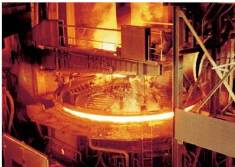
Figura N°1.9 Fusión de carga metálica en el Horno de Arco Eléctrico.
