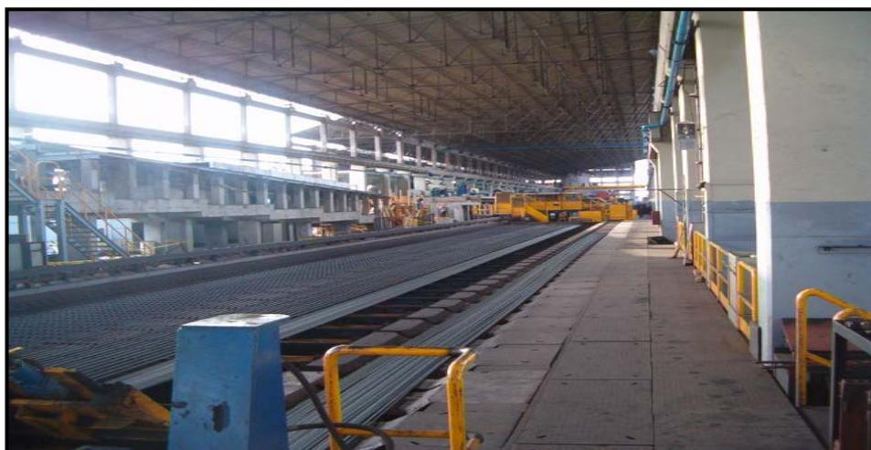
Figura N°1.31 Placa de enfriamiento de 60m.
