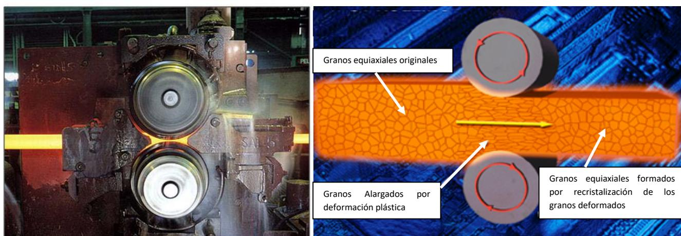
Figura N°1.24 Deformaci3n en caliente por acci3n de cilindros de laminaci3n.
