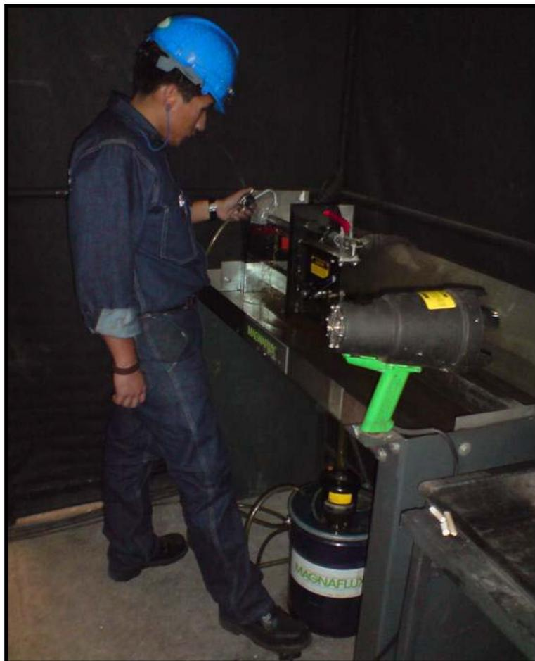
Figura N°3.21 Aplicación de partículas magnéticas fluorescentes húmedas, método continuo y con luz ultravioleta.
