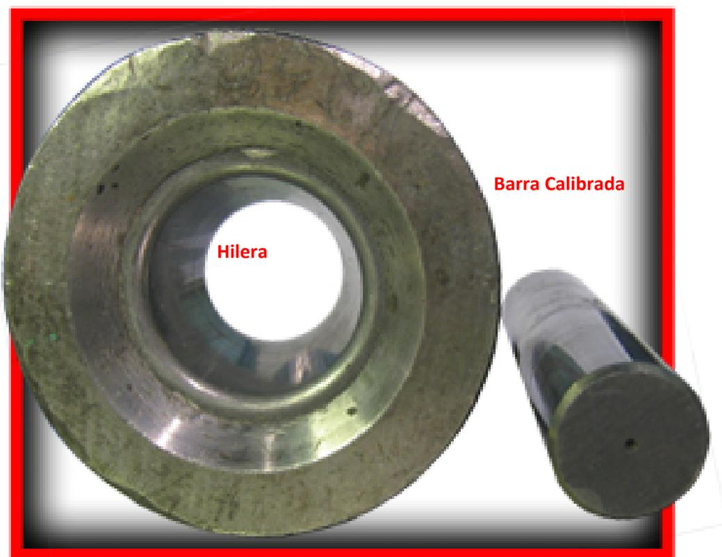
Figura N°1.37 Fotos de la hilera y Barra calibrada.
