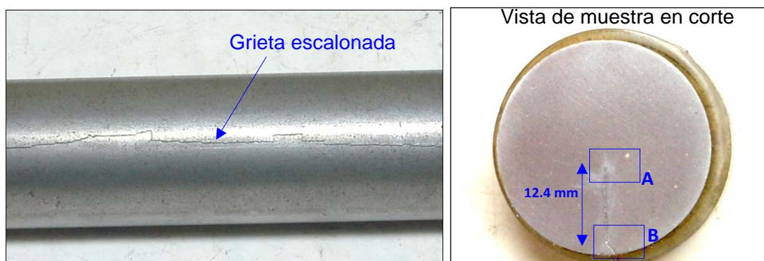
Figura N°3.34 Grieta escalonada en barra calibrada Ø1.1/8” calidad DIN9SMn28.
