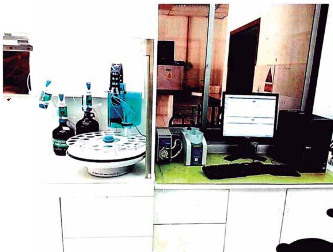
Figura 31: Fotografía de equipos para titulación potenciométrica instalados en el laboratorio químico de la Sociedad Minera Cerro Verde.
