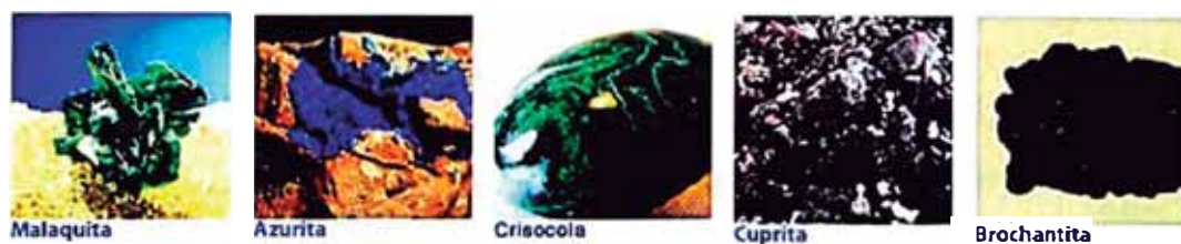
Figura 3: Muestras de minerales oxidados de cobre, de izquierda a derecha: Malaquita, Azurita, Crisocola, Cuprita, Brochantita (1) Fuente: CODELCO
