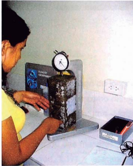
Fig. 3.16. Medición de las barras de concreto.
