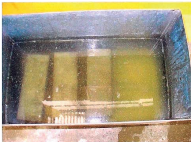
Fig. 3.17. Barras en solución de sulfato de magnesio.
