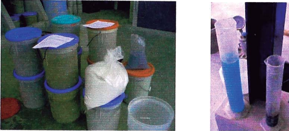
Fig. 2.2. Insumos. Lado Derecho: Aditivos (Celeste: Viscocrete 1, Marrón: Polyheed RI). Lado Izquierdo: Agregados, Cemento y Adiciones minerales
