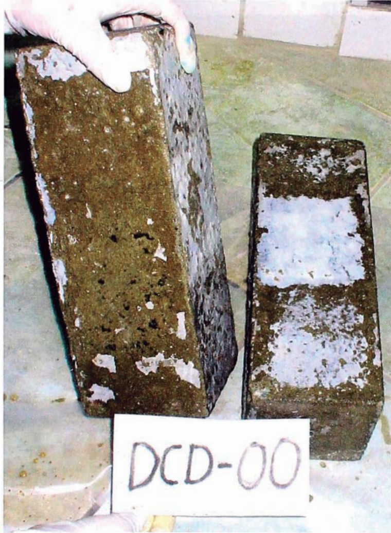
Fig. 3.18. Barras de Concreto del Diseño DCD-00 (No contiene adiciones minerales)
