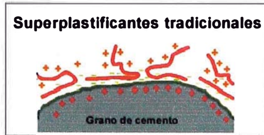
Fig. 1.8. Efecto de Repulsión Electrostática con Superplastificantes Tradicionales.
