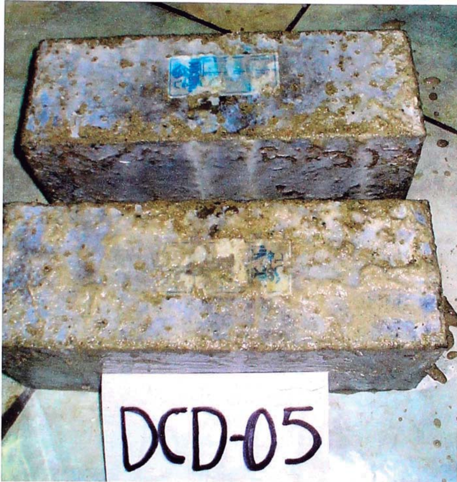
Fig. 3.19. Barras de Concreto del Diseño DCD-05 (Con 5% de Diatomita)
