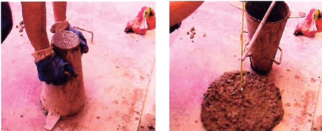
Fig. 3.5. Medición del Asentamiento usando el cono de Abrams
