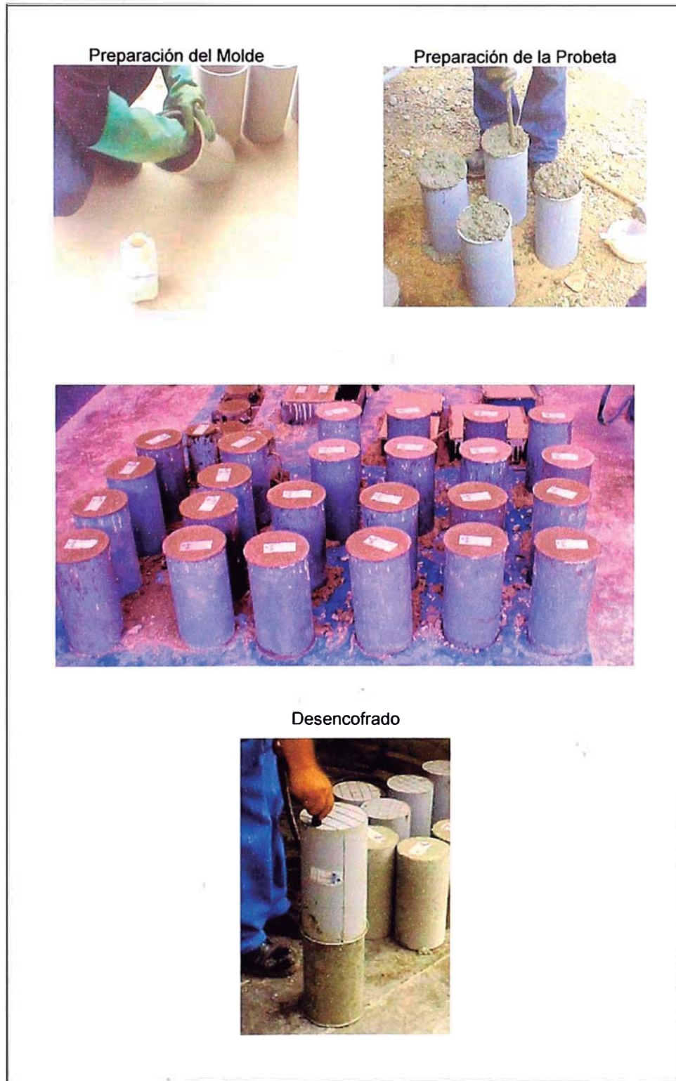
Fig. 3.8. Elaboración de las Probetas de Concreto
