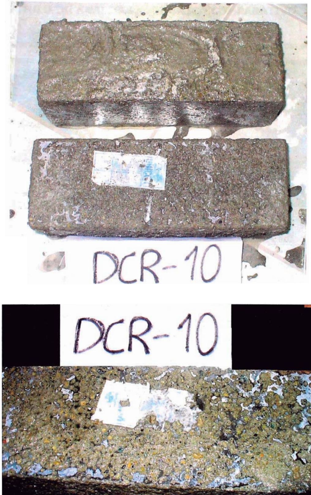
Fig. 3.22. Barras de Concreto del Diseño DCR-10 (Con 10% de Microsilíce)
