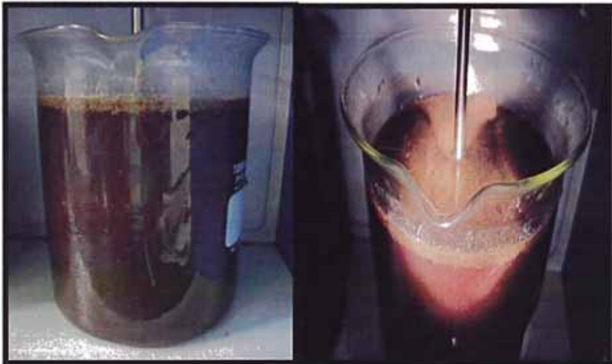
Figura 36: Muestra Salida del DAF con 200ppm LIPESA 1700 y 30ppm LIPESA 1520C
