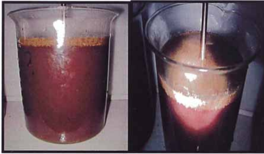
Figura 35: Muestra Salida del DAF con 200ppm LIPESA 1700 y 20ppm LIPESA 1520C
