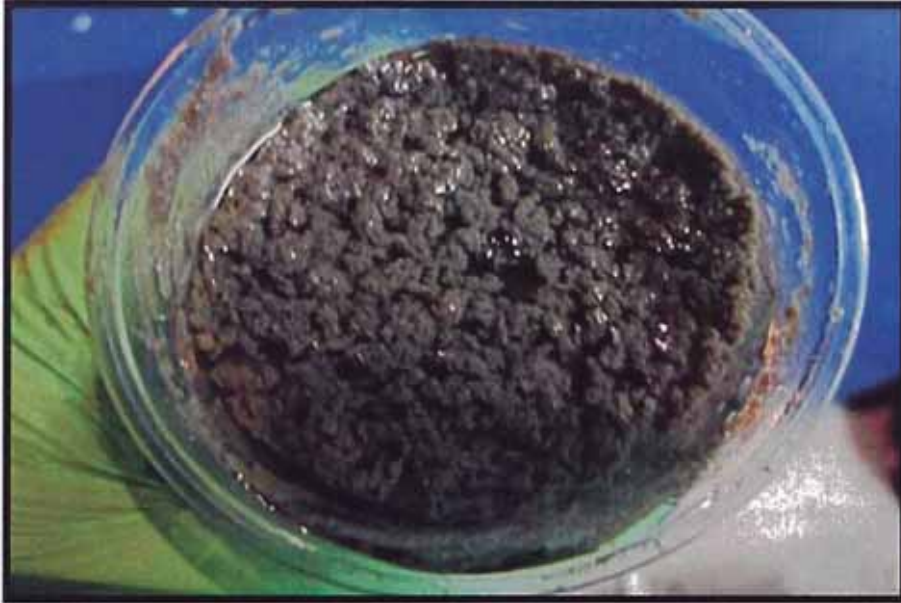
Figura 38: Prueba de jarras usando LIPESA 1700 en el lodo
