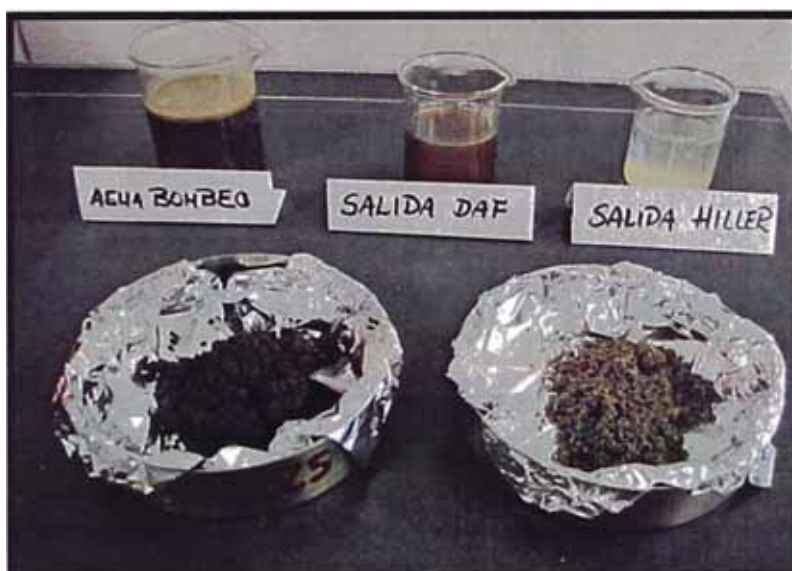
Figura 26: Muestras del Circuito tratamiento del agua de bombeo
