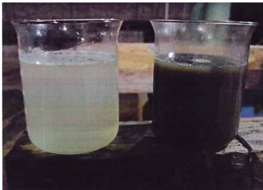
Figura 23: Salida e ingreso a la celda de clarificación
