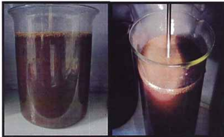
Figura 34: Muestra Salida del DAF con 200ppm LIPESA 1700 y 10ppm LIPESA 1520C
