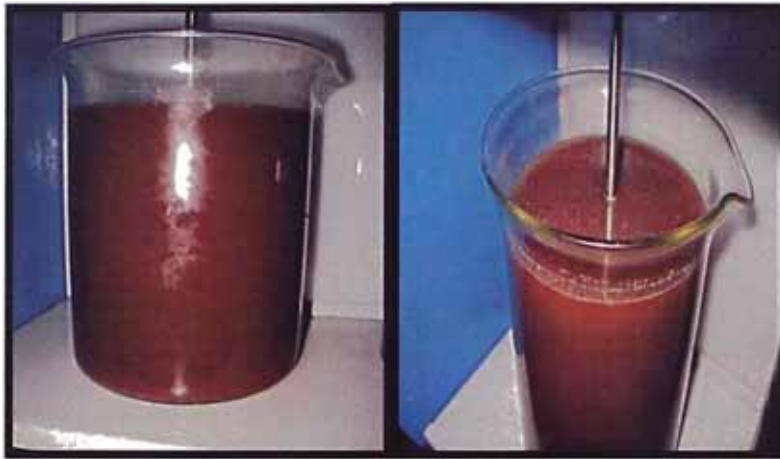
Figura 33: Muestra Salida del DAF sin agregar producto químico
