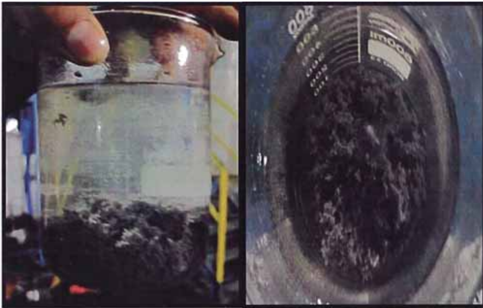
Figura 37: Prueba de jarras con el LIPESA 1700 simulando la celda de clarificación
