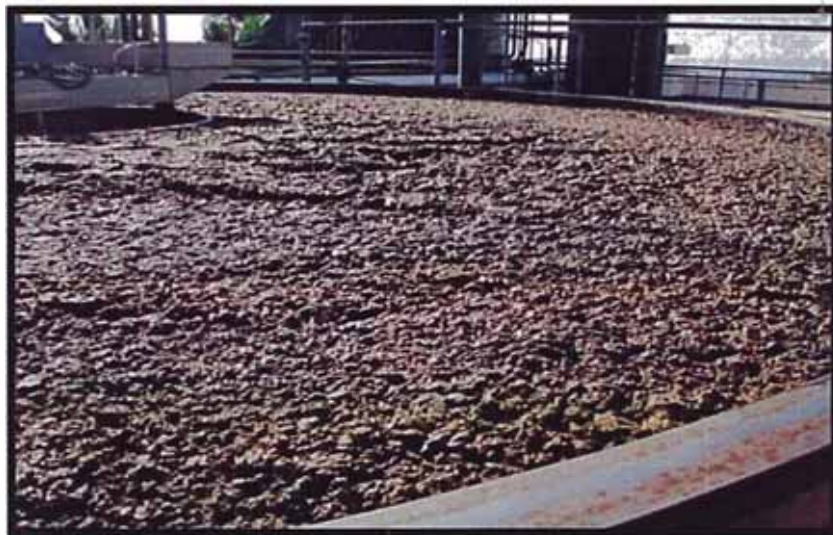
Figura 21: Torta Formada en la Celda de Clarificación
