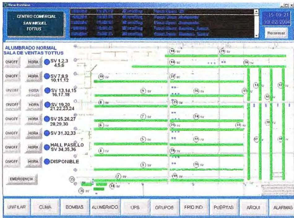
Figura 3.6, muestra una la disposición de equipos de alumbrado en la sala de ventas de la tienda Tottus
