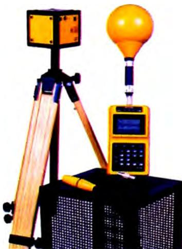
**Fig. 5.1** Analizador de Campo Electromagnético para baja frecuencia
