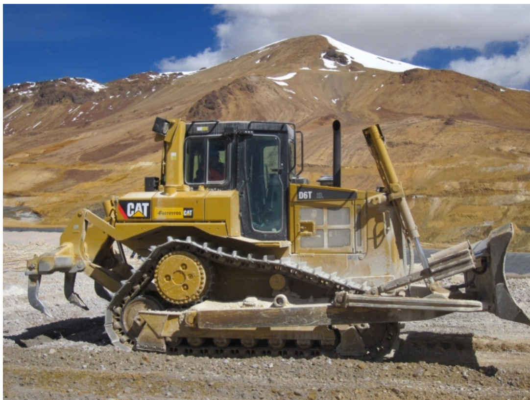
Figura N° 2.22 Empuje y Escarificado de Mineral.
