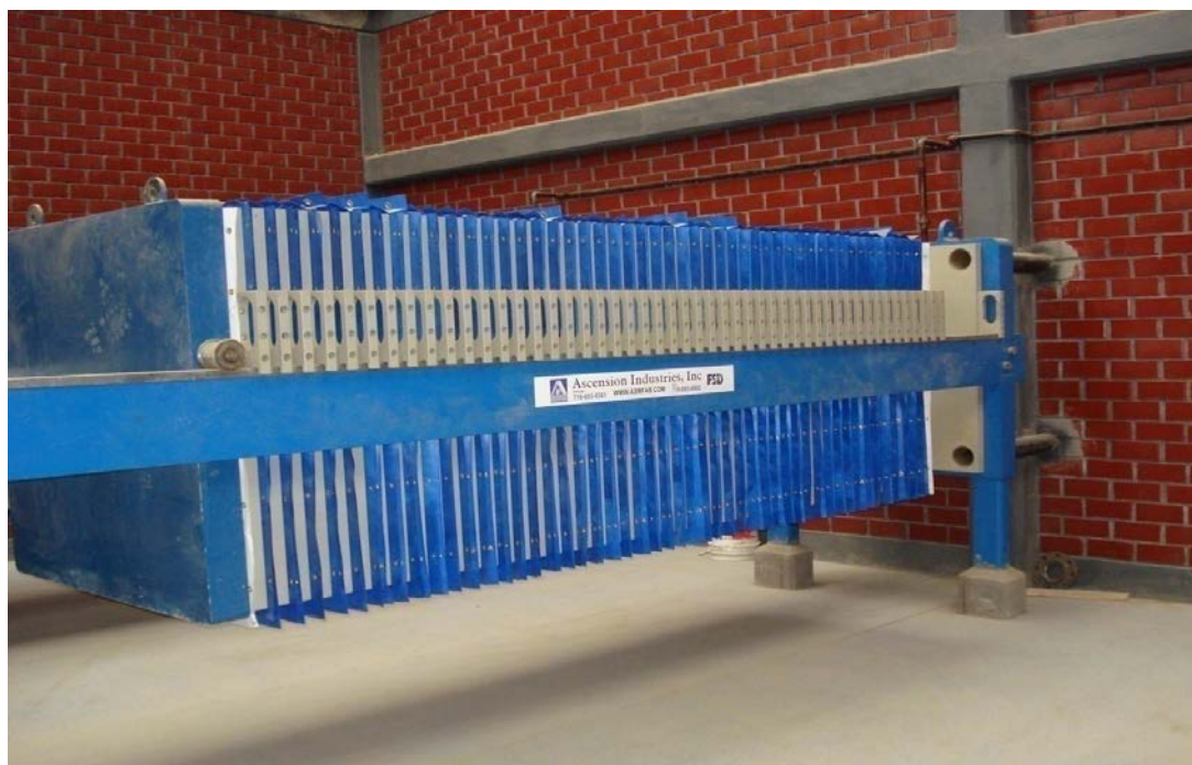
Figura N° 2.34 Filtros Prensas, modelo QP1500-32-140, marca Durco Filters.
