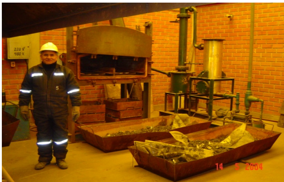
Figura N° 2.35 Precipitado listo para ser secado en los hornos retortas.
