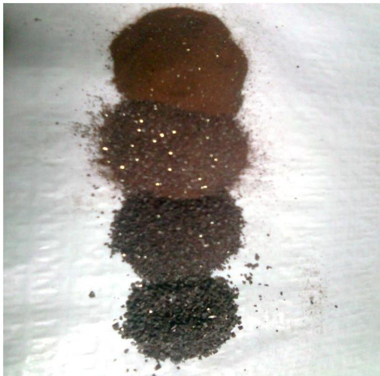
**Figura N° 3.8:** Se aprecian los refinados finales para mallas 1/32, +28, +65 y -65
