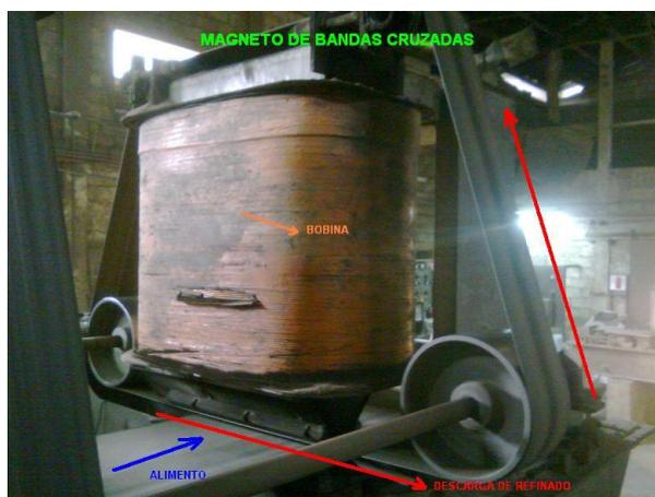
**Figura N° 3.3:** Magneto de refinación
