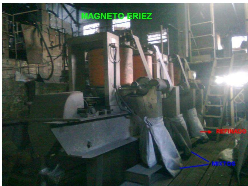
**Figura N° 3.4:** Se aprecia la descarga de concentrados y mixtos
