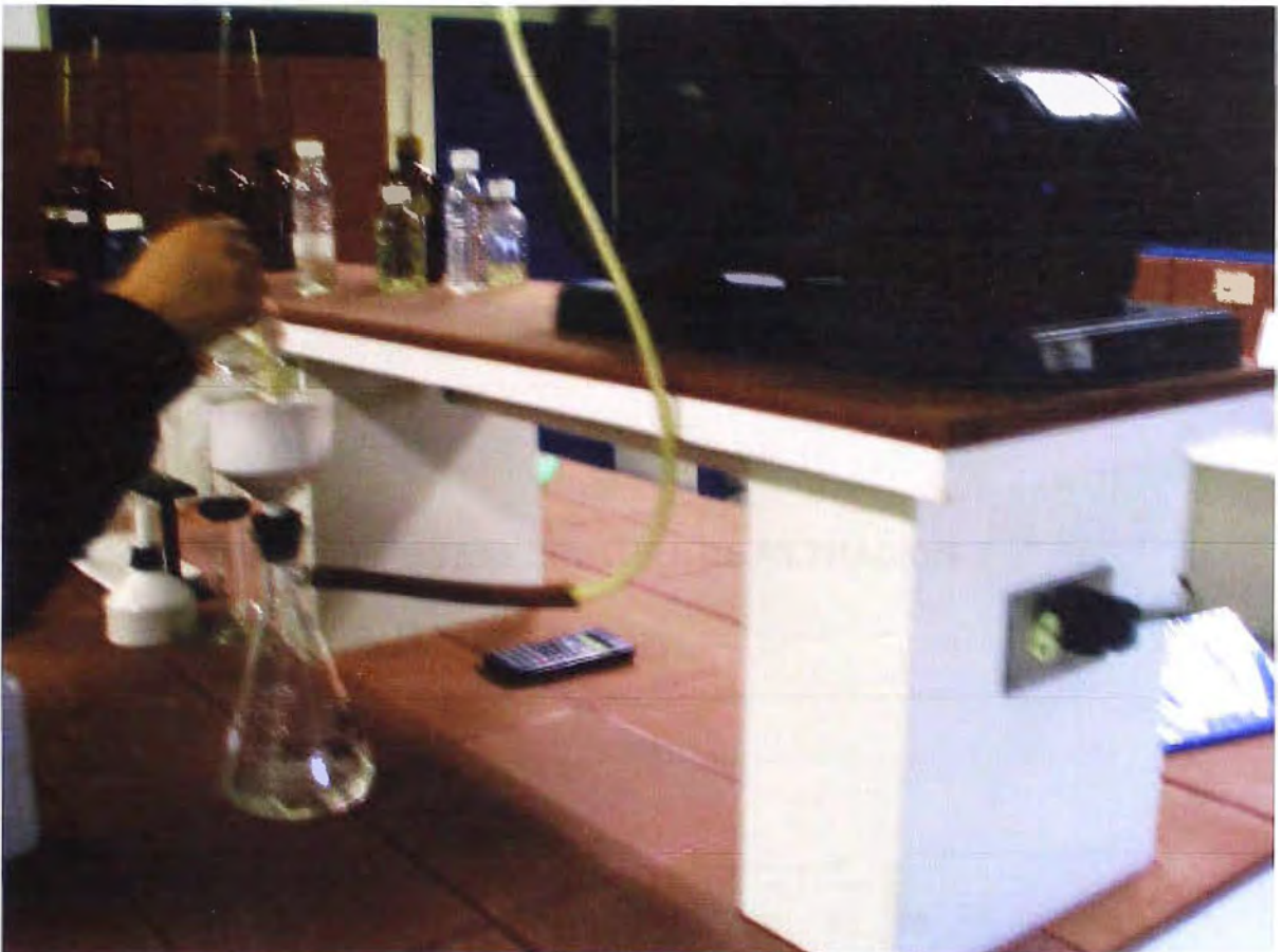
Figura № 5: Determinación de Contenido de Insolubles
