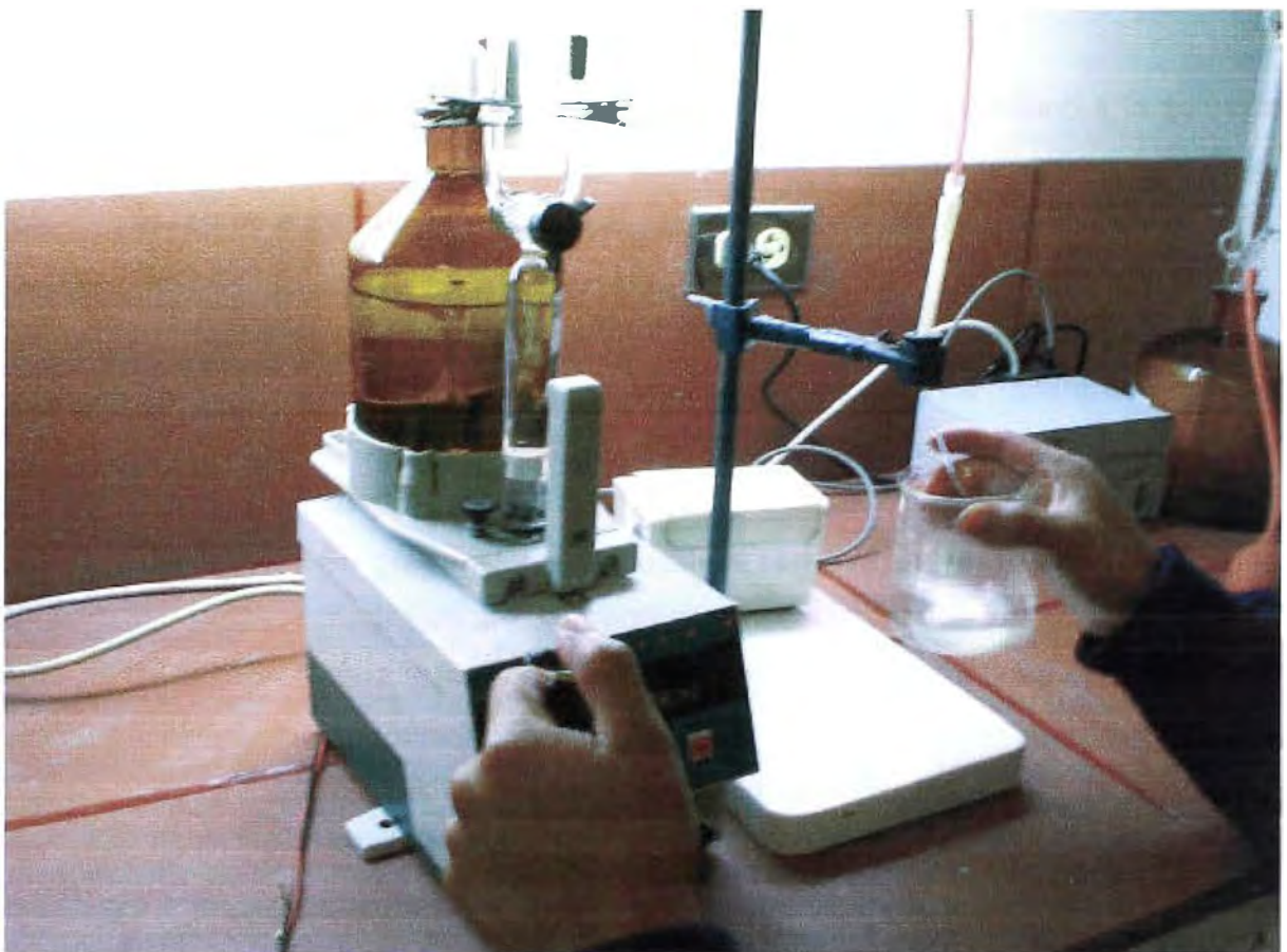
Figura № 3: Determinación de Contenido de Magnesio en Titulador Automático
