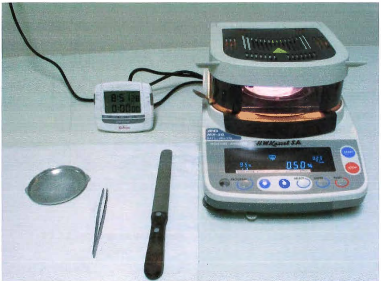
Figura № 4: Determinación de Humedad del SMH
