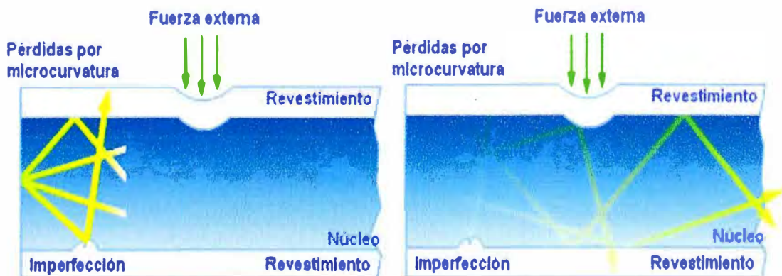
Fig 2.20.-Microcurvaturas en la fibra óptica.
