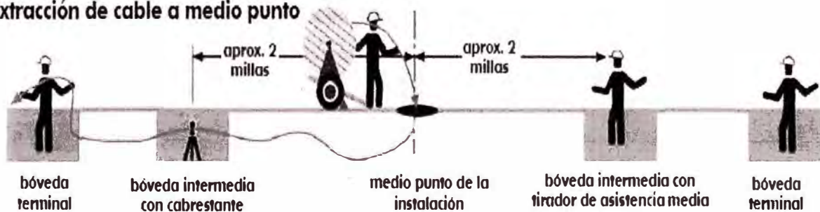
Fig 3.41.-Representación de técnica de tracción a medio punto.
