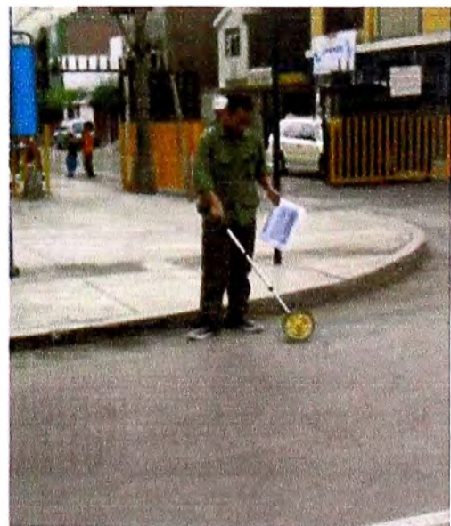
Fig 3.19.- Implementos para el estudio: GPS Garmin 72H(Izquierda),Rolla(Centro) y Modo de uso de la rolla durante la medición de distancia entre postes(Derecha).
