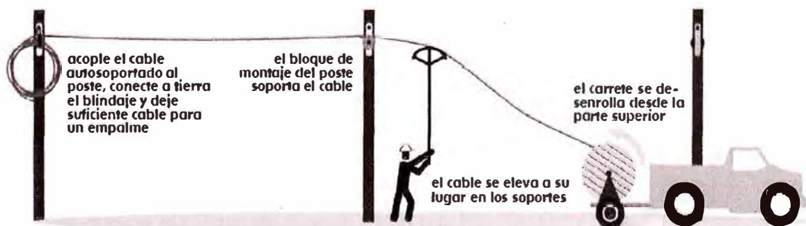
Fig 3.30.-Proceso de instalación de cableado aéreo mediante desplazamiento de carrito.
