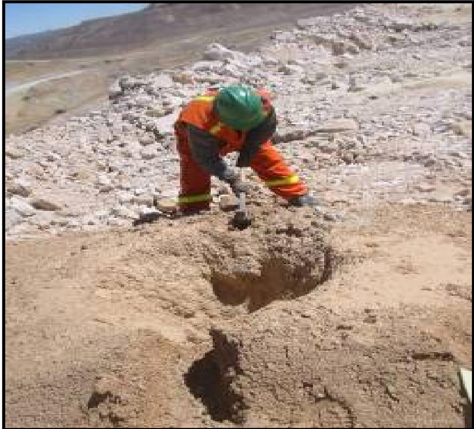
**FIGURA N° 45.- Toma de muestreo usando la hachuela**
