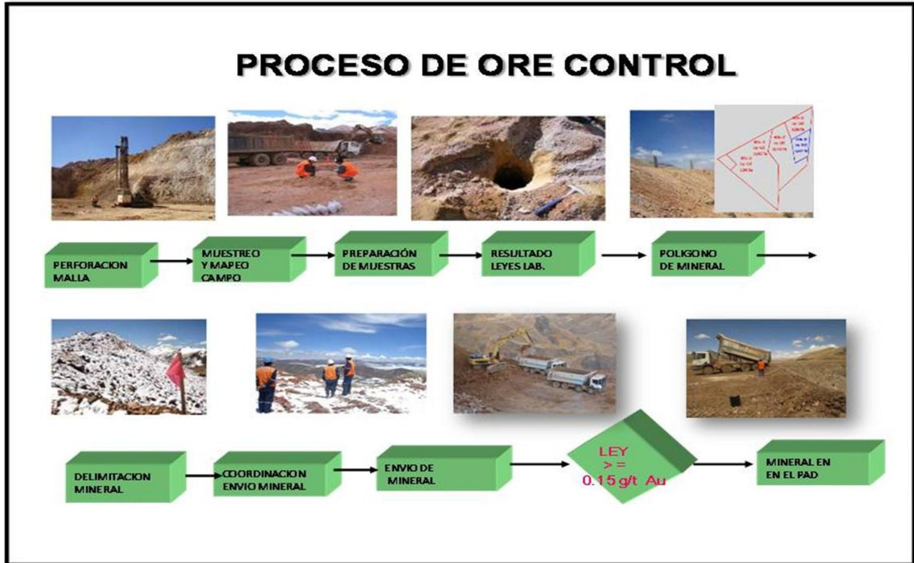
Figura N° 14 Flow chart del Proceso de Ore Control
