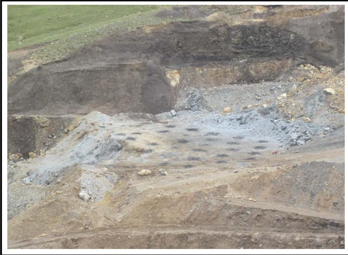
**FIGURA N° 50.- Malla con taladros de producción argilizados**
