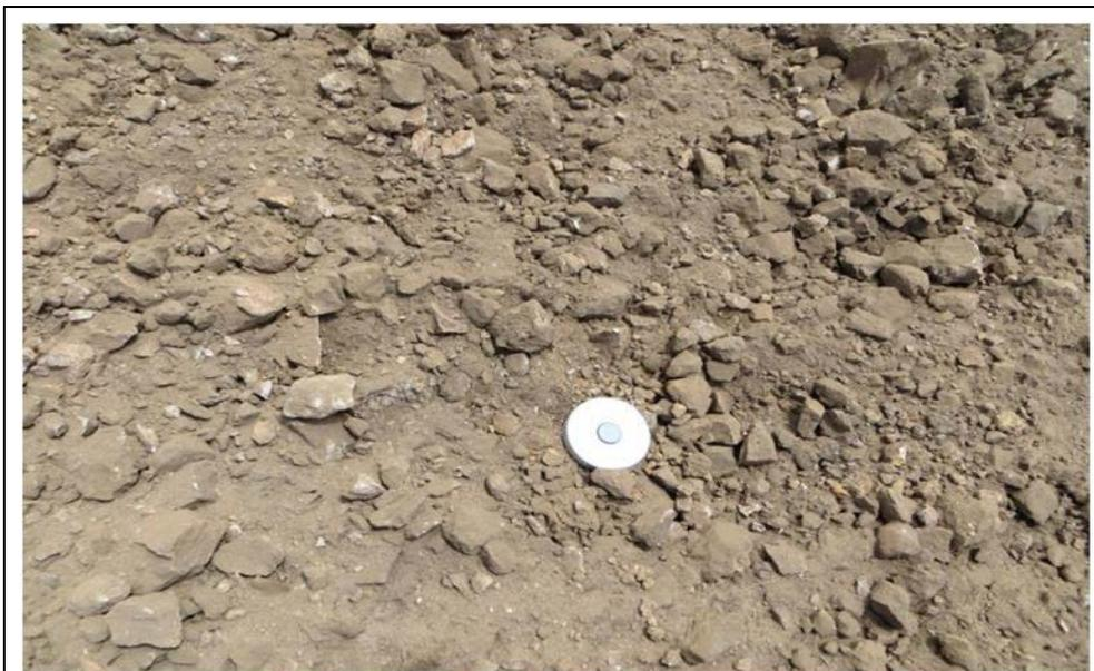
**FIGURA Nº 16.- Granulometria de voladura entre 1" a 4" de diámetro**
