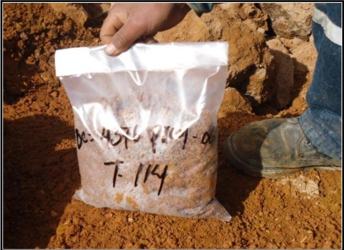
**FIGURA Nº 49.- Embolsado y etiquetado de la muestra**
