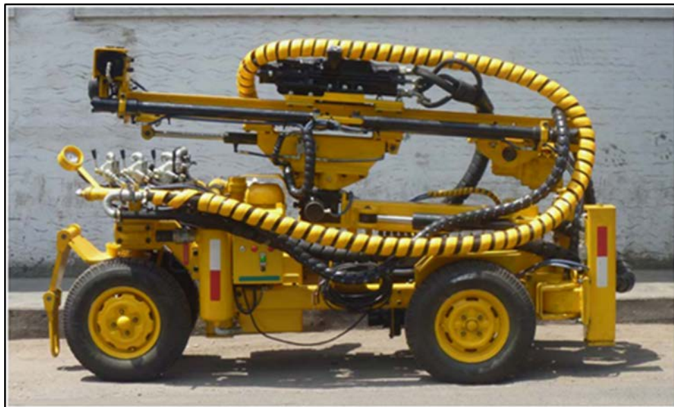
Figura 7.1 Equipo de perforación neumático (colibrí).
