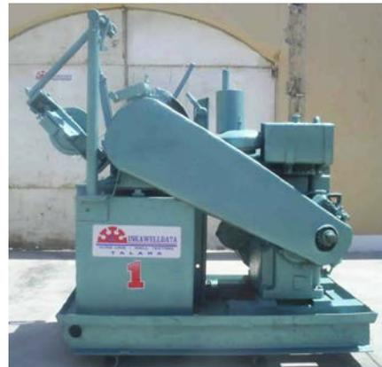
El motor provee la fuerza y movimiento para transmitir la rotación al eje con menor diámetro, el cual a su vez hace lo propio a otro eje de mayor diámetro mediante una cadena de arrastre para lograr la rotación al fin del winche donde va enrollado el alambre, el mismo que pasa finalmente por el contómetro que tomará las lecturas de profundidad.
