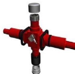
Está compuesto internamente de unos cauchos de vinilo (“rams”) diseñados para aislar hasta 5,000 ó 10,000 psi según sea el caso mediante la operación de cierre con sus “orejas”. Dependiendo del trabajo a realizar, pueden tener diámetros de  $2\frac{3}{8}$ ”,  $2\frac{7}{8}$ ”,  $3\frac{1}{2}$ ” (fig. 3)
