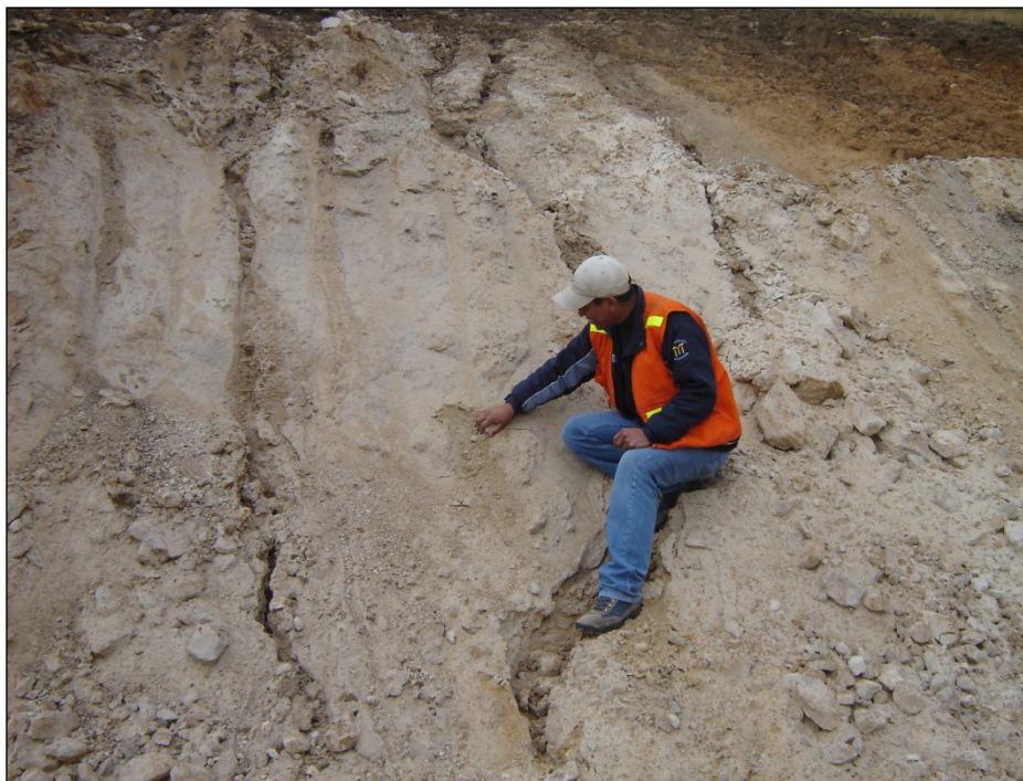
Foto 3.7. Se aprecia un afloramiento con alteración sílice granular, de color blanquecino, con manchas de óxidos y muy deleznable.
