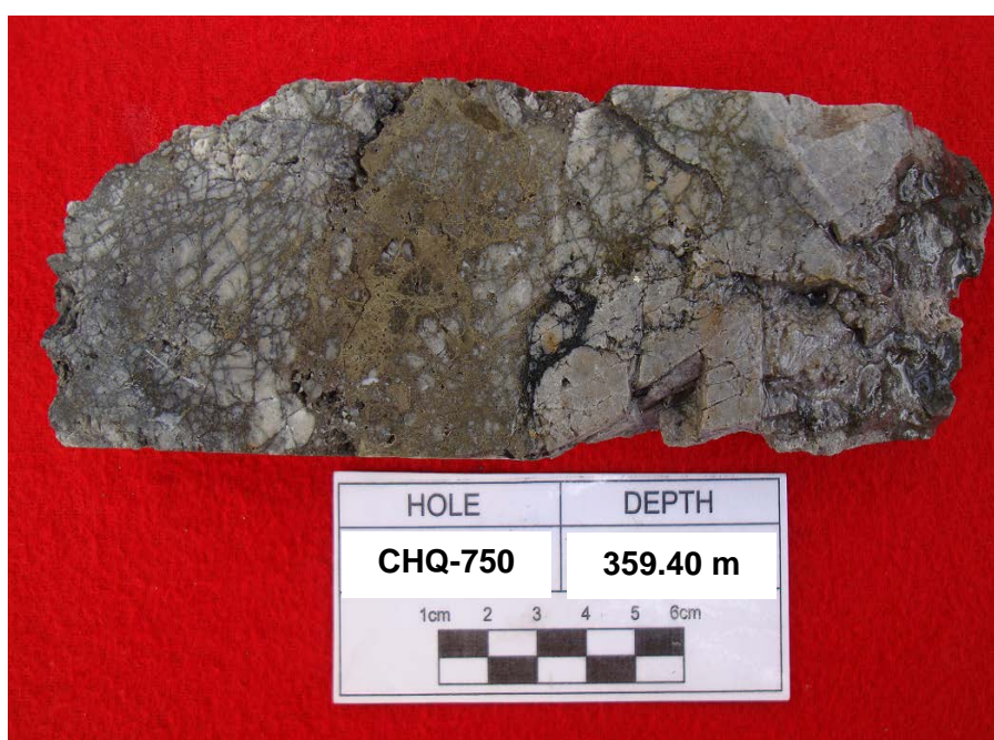
Foto 3.5. Se aprecia una brecha hidrotermal con textura rotacional (centro) a craquel (bordes), matriz rellena con sulfuros (pirita y enargita)
