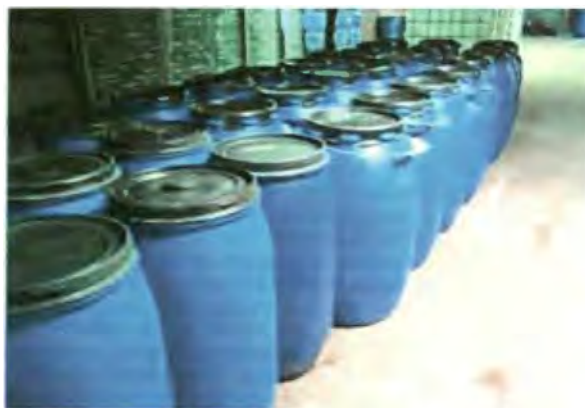
Figura 8: Envases de plástico (generalmente para almacenar residuos corrosivos)
