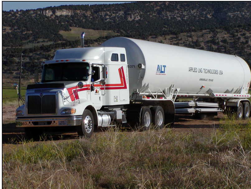
Figura N° 12: Camión con tanque Criogénico
