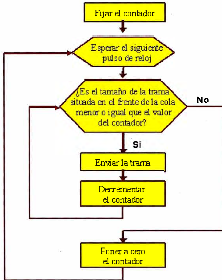
Fig.1.20 Diagrama de flujo de algoritmo del cubo con escape.
