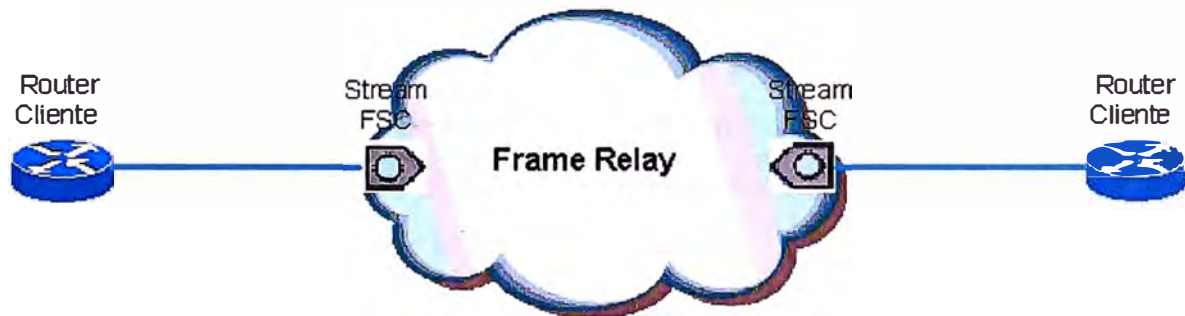
Fig.3.3 Conexión al Stream FSC, Switch Frame Relay.
