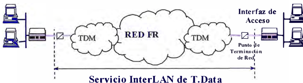
Fig. 1: Alcance del Servicio Frame Relay
