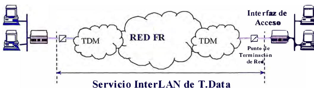
Fig. 1: Alcance del Servicio Frame Relay
