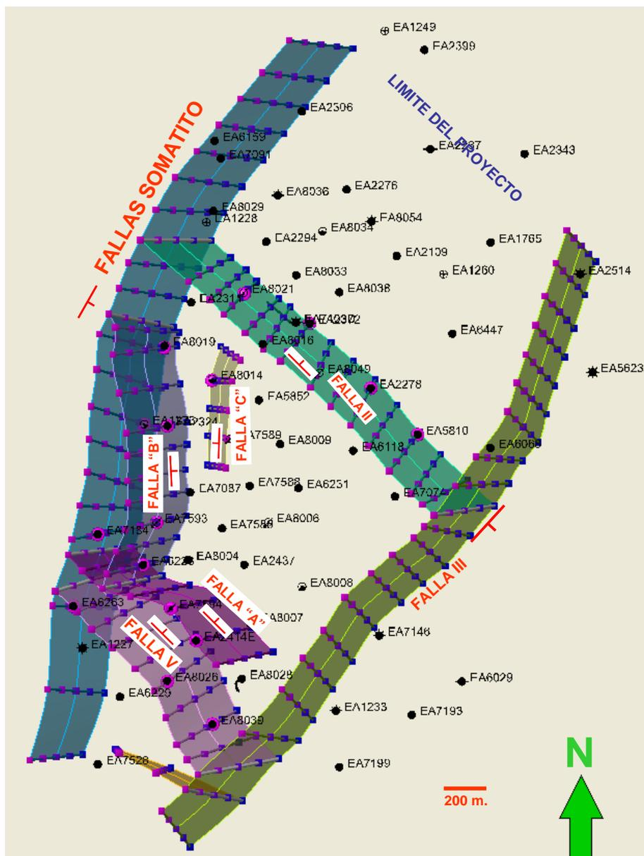
Figura 57 - Modelo estructural tridimensional basado en polígonos de falla en el tope y en la base de la Formación Verdún.
