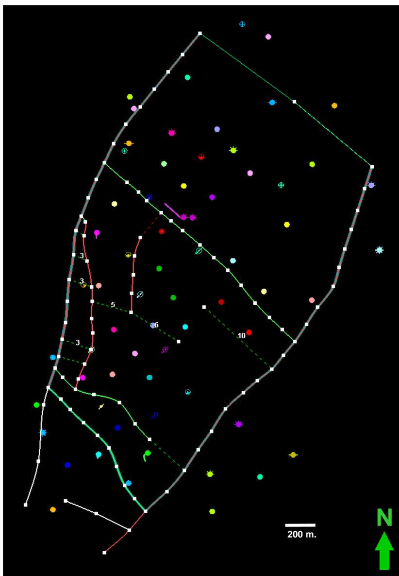
Figura 58 – Se pueden observar las fallas (líneas continuas), los pilares de falla (cuadrados blancos) y las direcciones locales (líneas discontinuas) utilizados en la construcción de la grilla a través del proceso de *Pillar Gridding*. Los números en blanco indican la cantidad de celdas a generar en dicha dirección local (línea discontinua).
