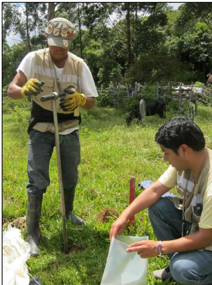
Figura 4.4, Se observa el muestreo en suelos por medio del aparato llamado auger, se retira todo el horizonte A, para proceder a muestrear 4kg del horizonte B.
