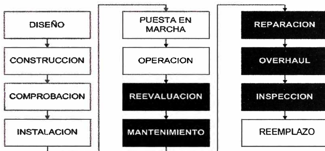
Figura N° 3.2: Ciclo de vida del Transformador
