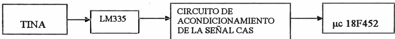
Figura 2.4 Bloques que describen el comportamiento de la adquisición de datos
