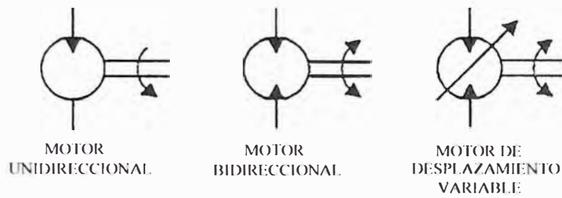
Figura 1.24: Símbolos de motores hidráulicos rotativos
