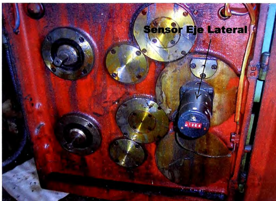
Figura 2.8: Sensor desplazamiento Lateral y engranajes para el cambio de dirección en 4 sentidos
