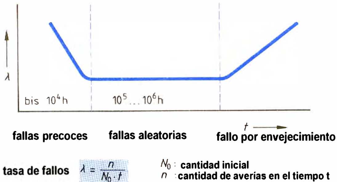
Figura 5.7: Diagrama de eventos de fallas en función del tiempo de vida del equipo
