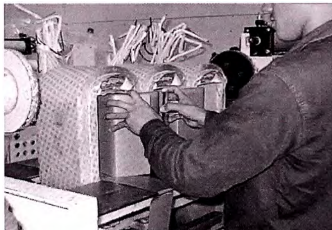
Figura 5.4 Reparabilidad de los transformadores con núcleo enrollado.
